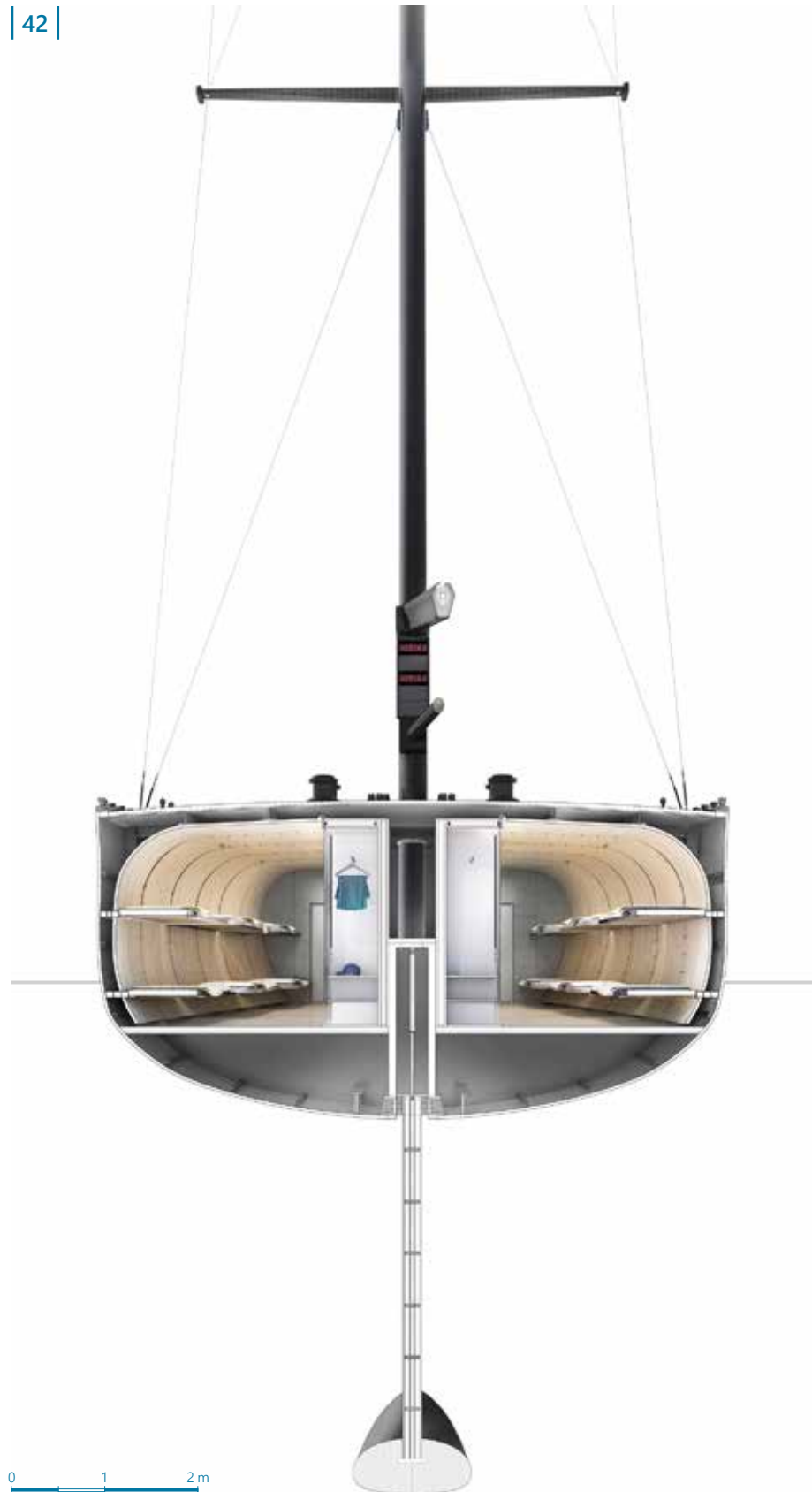
Fig. 42 Sezione trasversale D-D': in evidenza la lifting keel con apposito spazio tecnico isolato nel nucleo centrale del piano di sottocoperta
