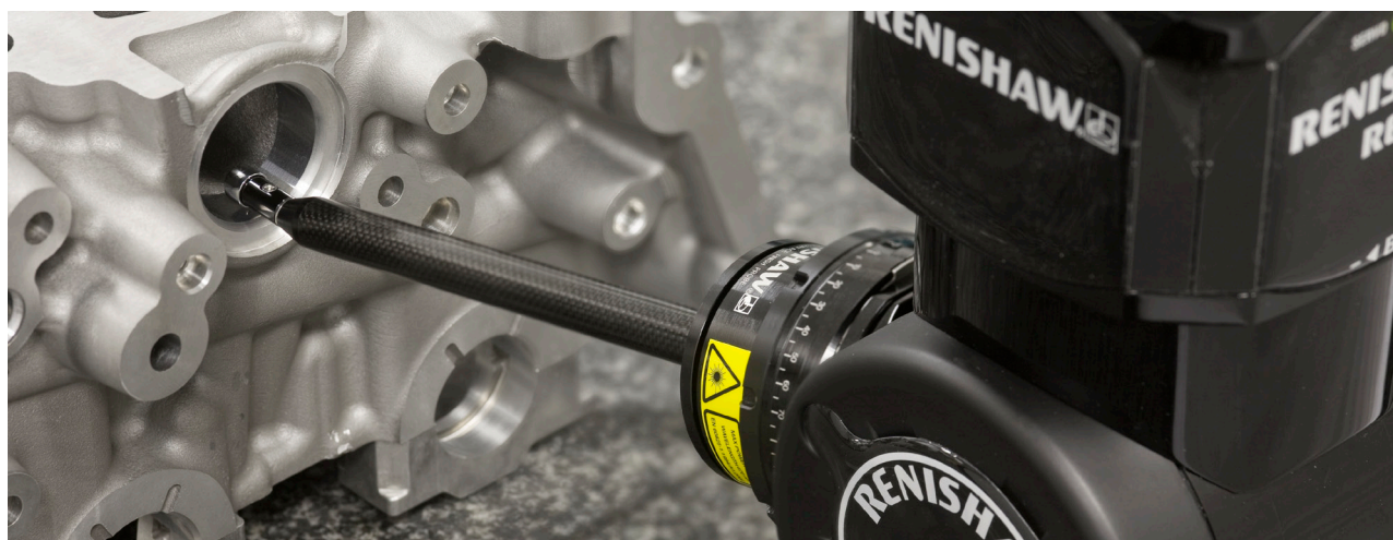
Fig. 3.6 - Esempio di scanner CMM a contatto, con misurazione su 5 assi. [fonte: http://www.renishaw.com/en/scanning-probes-6656 ]
