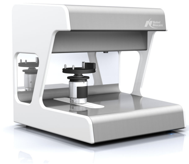
Fig. 2.8 - NobelProcera™ Scanner, sistema conoscopico. [fonte: http://www.nobelbiocare.com/en ]
