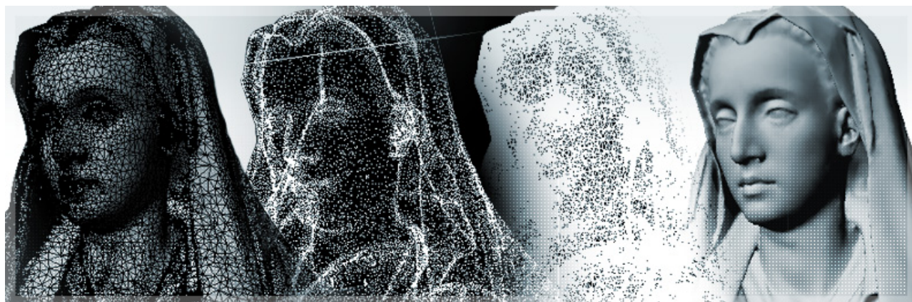
Fig. 2.12 - Digitalizzazione mediante scanner 3D di un volto. Si riconoscono le varie fasi della scansione, dalla fase di meshing fino ad arrivare al modello digitale finito. [fonte: http://www.3deverywhere.com ]
