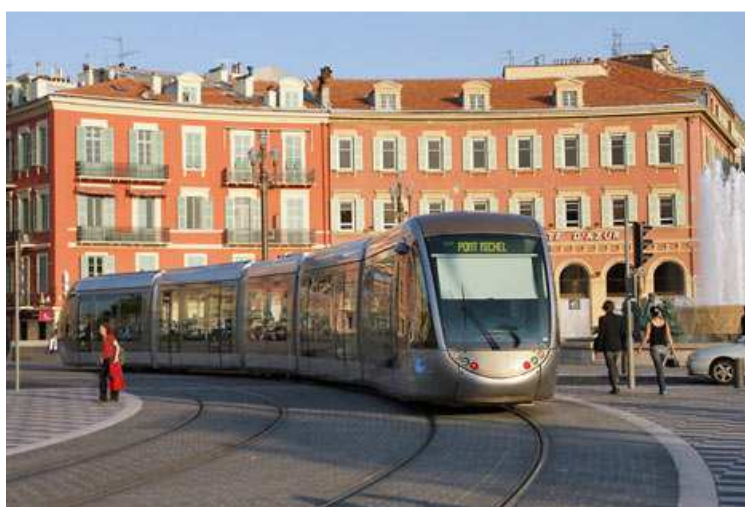
Figura 27 – Tram a batterie di Nizza, Linea 1, Piazza Masséna
