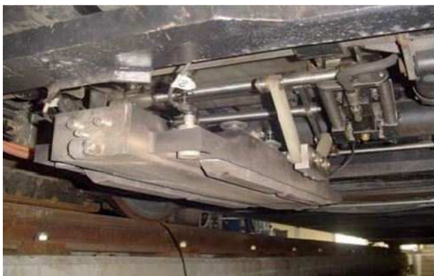
Figura 23 – Captatore installato a bordo di un tram
