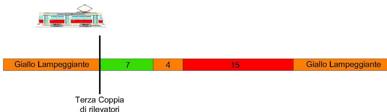
Figura 33 – Ciclo semaforico attuato dalla metrotranvia passando sulla terza coppia di boe
