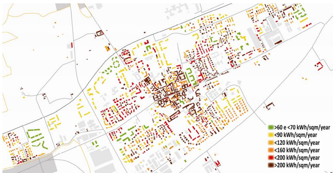
Figura 2.6 Dettaglio della mappa del fabbisogno di calore per riscaldamento degli edifici del comune di Gorgonzola (Troglio et al., 2010)
