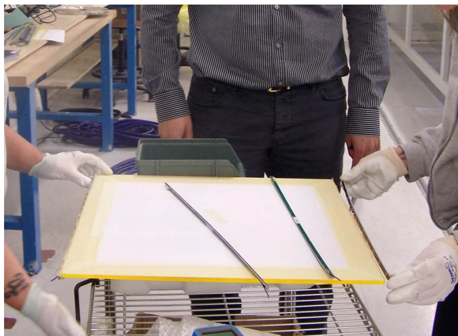
Figura 10 - Posizionamento delle strisce di celle assemblate ai bus sui lati della lastra in PMMA.
