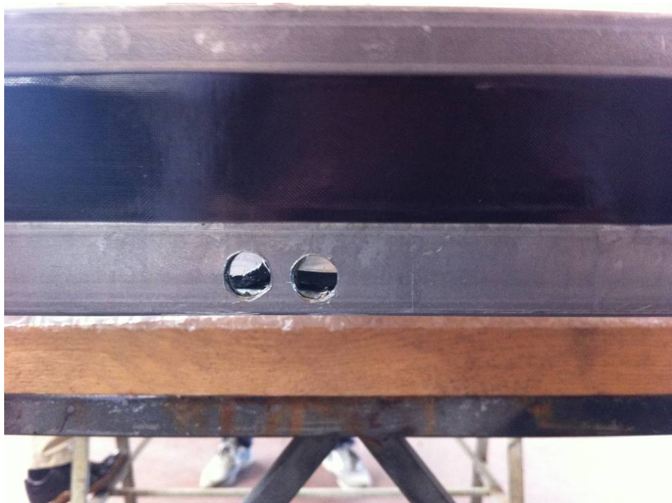
Figura 19 – Foro per l'uscita dei cavi nella parte superiore del modulo
