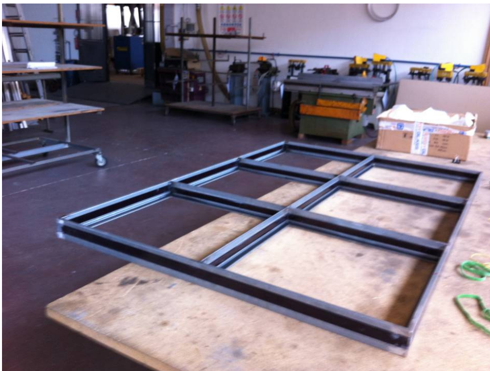
Figura 13 - Telaio del modulo LSC 3x2 pannelli, vista del lato corto (1084mm).
