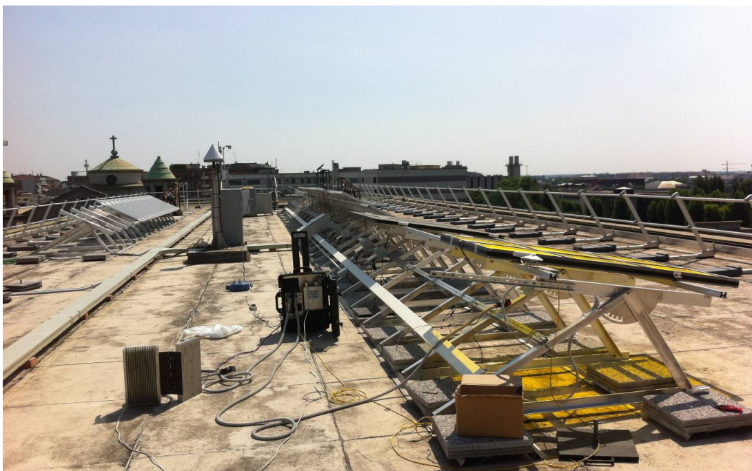
Figura 24 - Sito sperimentale per il monitoraggio del modulo LSC con i dispositivi di misura allestiti e collegati al modulo.
