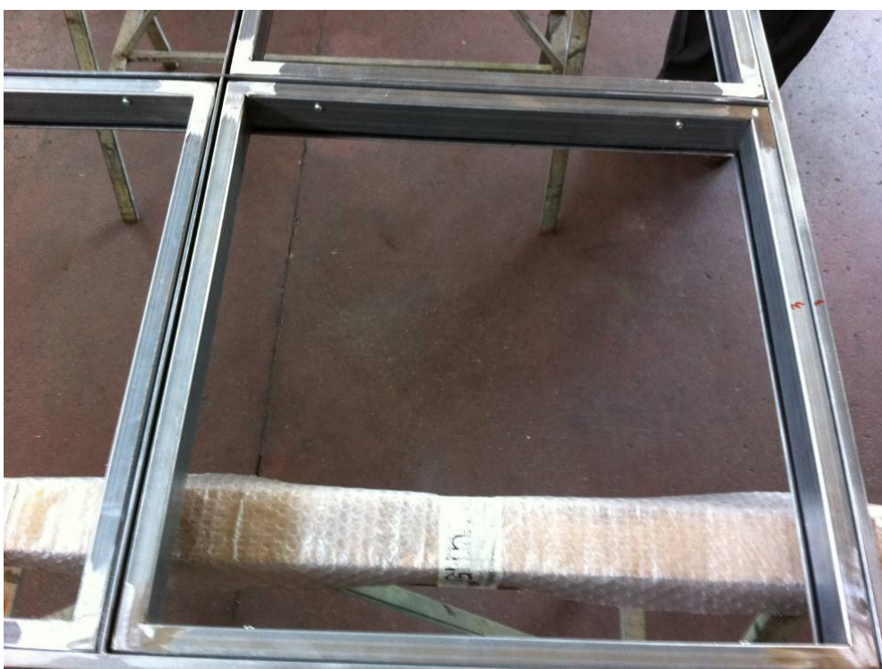
Figura 14 - Fronte posteriore del modulo, scatolato per il bloccaggio dei pannelli LSC.
