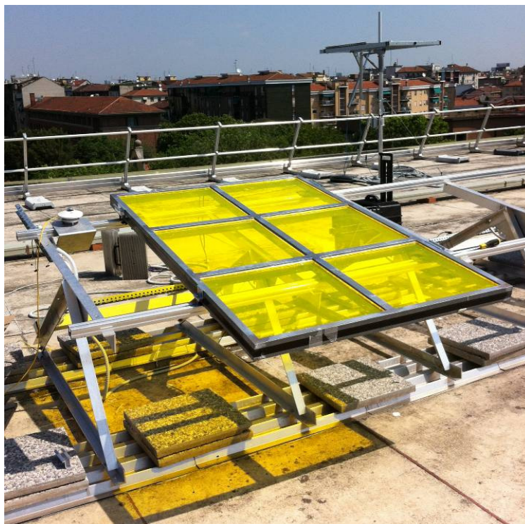
Figura 25 - Prototipo LSC di ENI realizzato con 6 pannelli posizionati sui cavalletti della Test Facility.
