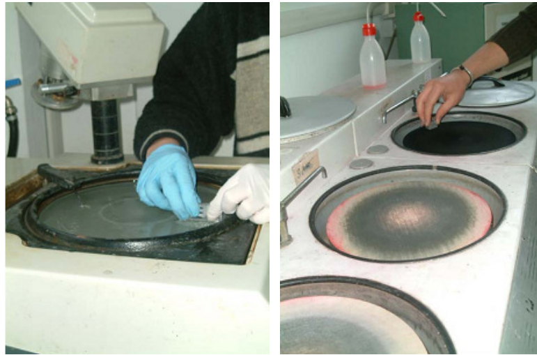
Fig. 3.13 – La spianatura, a sinistra, e la lucidatura ai panni, a destra.
