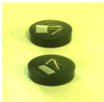
Fig. 3.11 – Esempio di campione metallico inglobato nella resina
