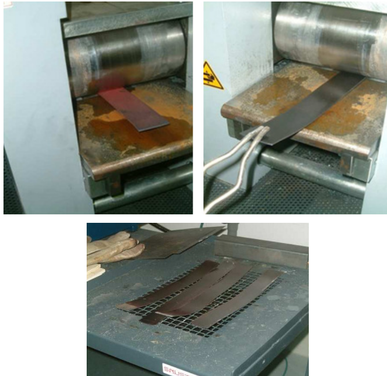
Fig. 3.3 – Ingresso ed uscita di una billetta dal laminatoi e successivo raffreddamento in aria mossa
