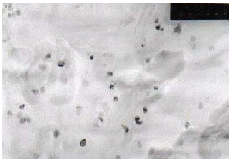
Fig. 2.3 – Esempi di carburi di vanadio di dimensioni nanometriche osservati mediante microscopio elettronico a trasmissione (TEM)
