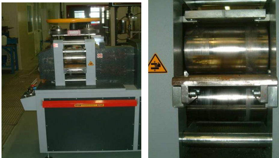
Fig. 3.2 – Laminatoio utilizzato per la produzione dei campioni e particolare dei rulli di laminazione
