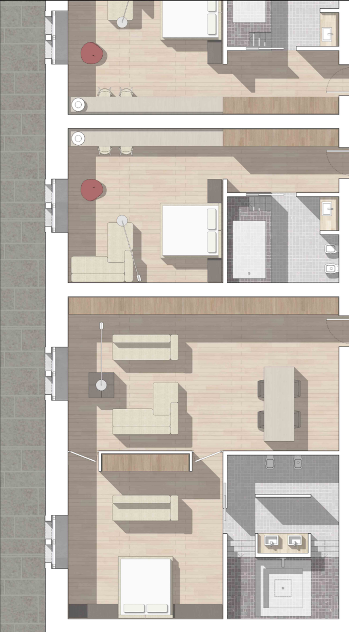
Pianta della tipologia della camera singola e dopia - Scala 1:50
