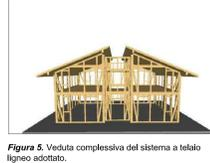
Figura 5. Veduta complessiva del sistema a telaio ligneo adottato.
