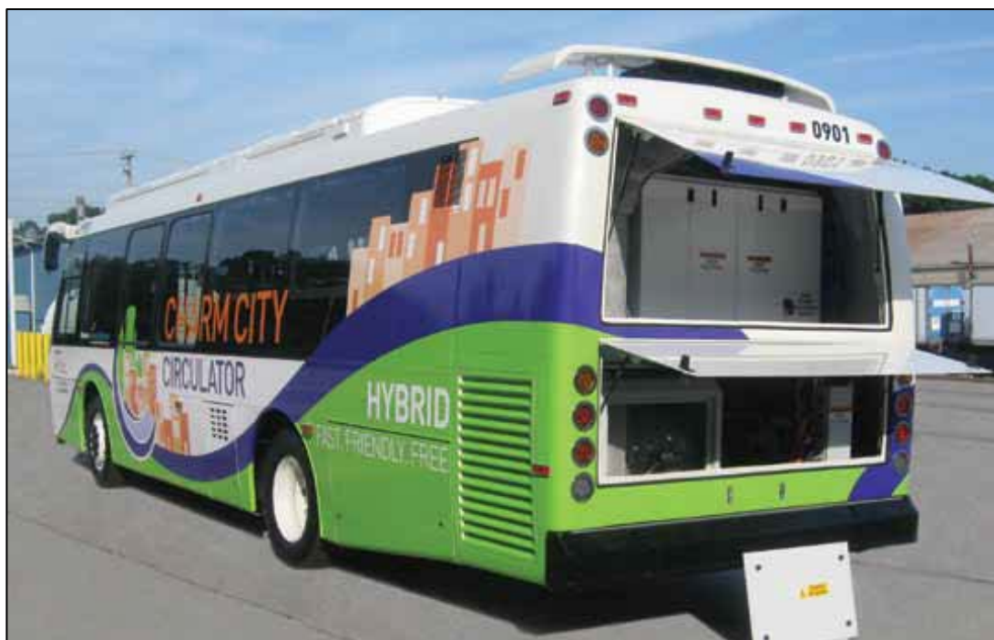
Figura 7-1: autobus ibrido con microturbina in servizio a Baltimore
