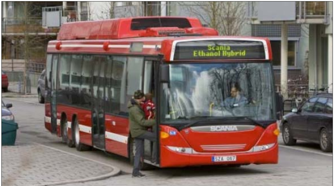
Figura 6-3: Autobus ibrido Scania alimentato ad bioetanolo
