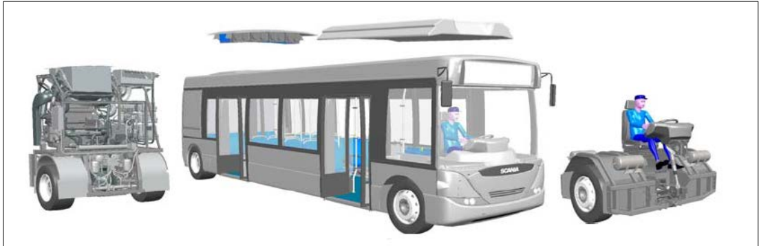
Figura 6-5: componenti della catena cinematica della trazione ibrida Scania
