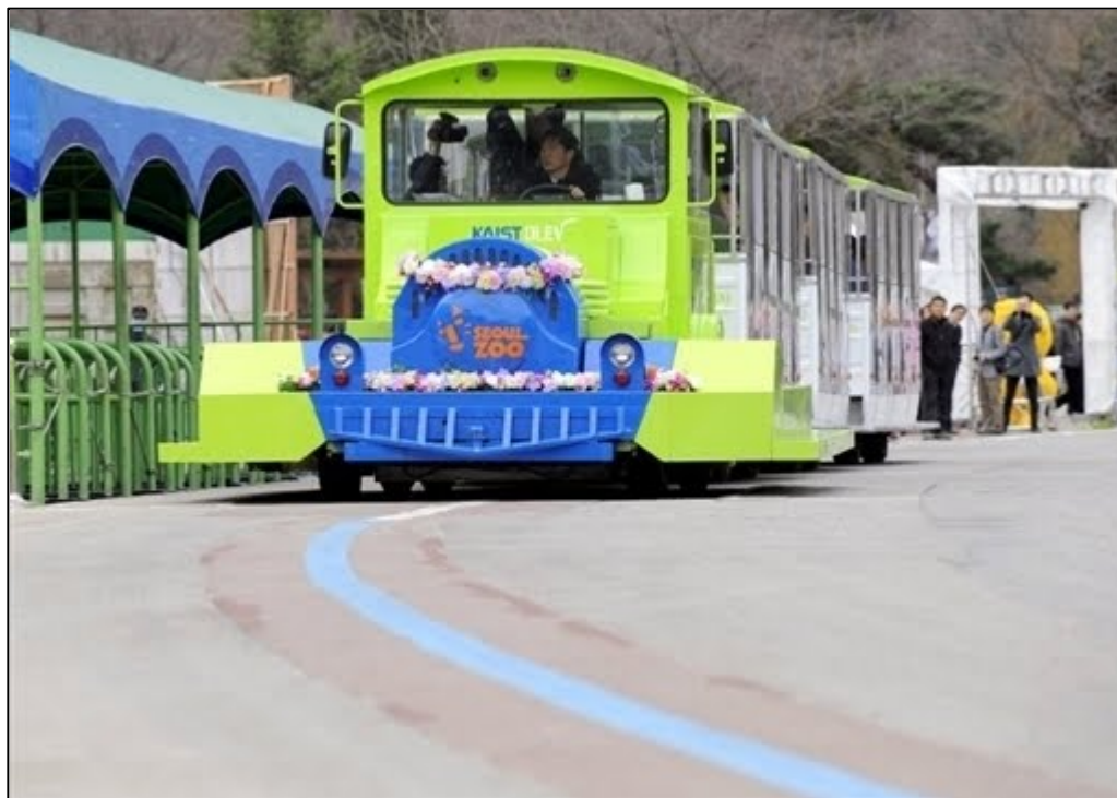
Figura 6-20: veicolo OLEV e strisce di ricarica
