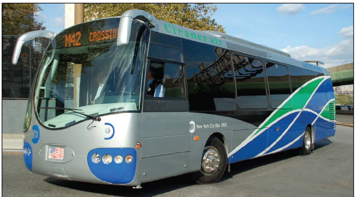
Figura 7-12: autobus ibrido con microturbina DesignLine EcoSaver IV
