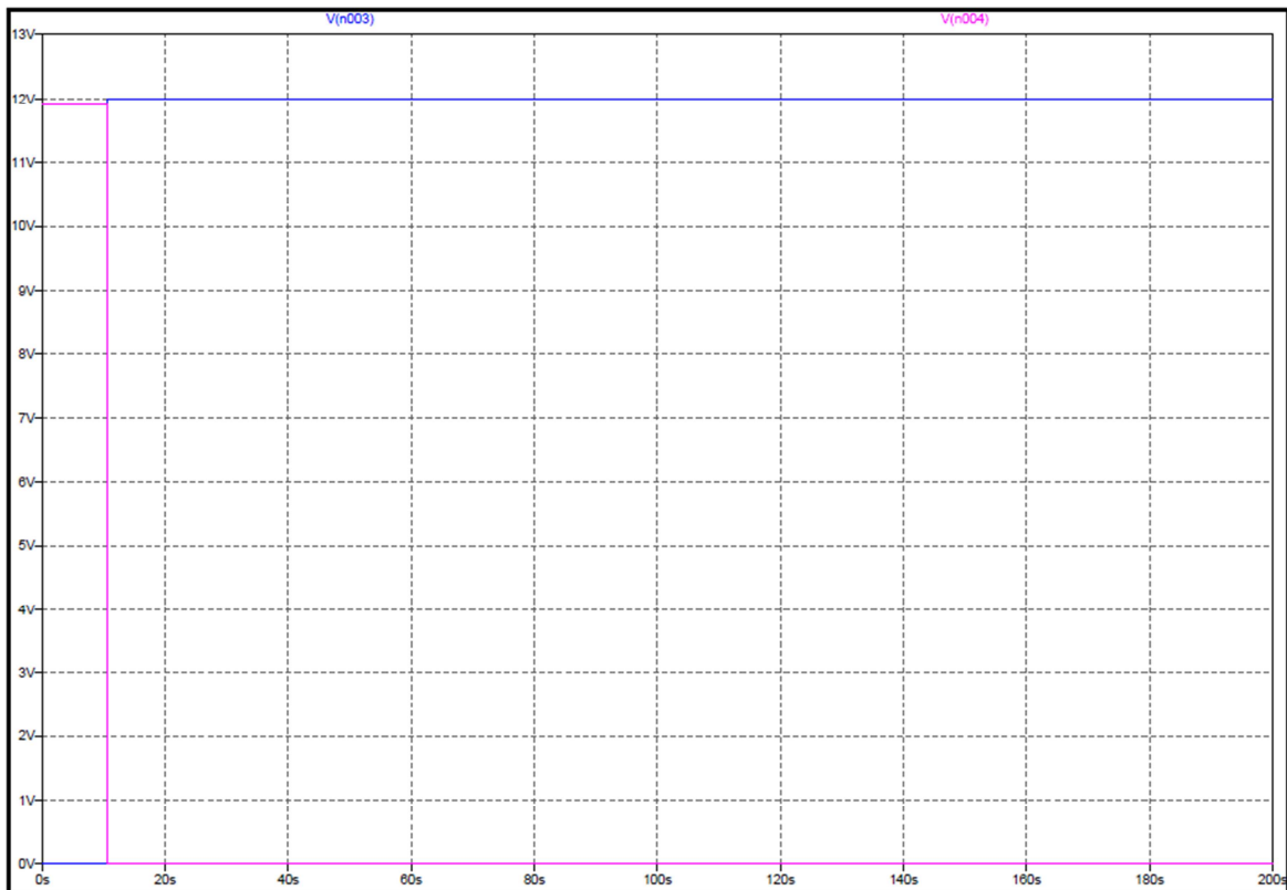
Fig. 3.20 – La curva viola rappresenta la tensione sul collettore del BJT; la curva blu rappresenta la tensione in uscita dall'amplificatore
