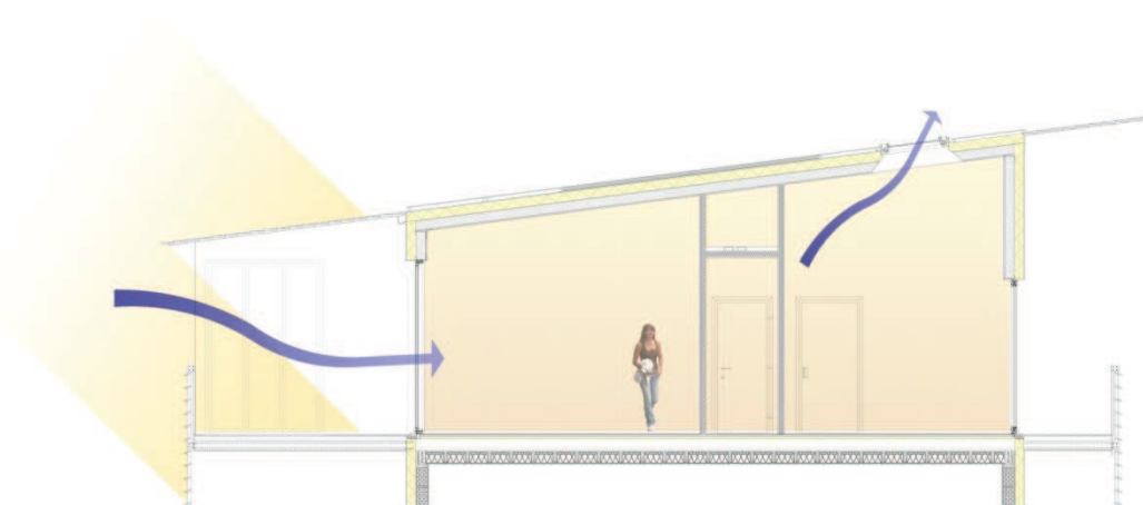
Figura 24: funzionamento energetico nelle stagioni intermedie, autore tesi
