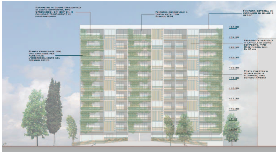
Figura 12: Prospetto ovest, autore tesi
