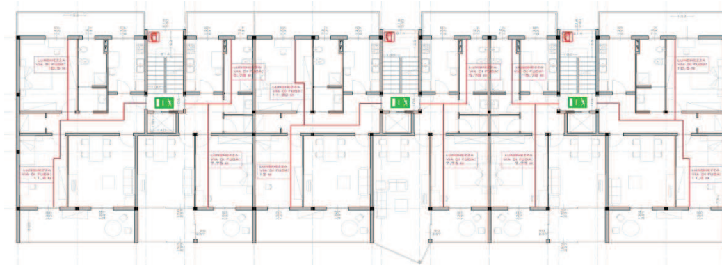
Figura 21: pianta di un piano tipo con indicazione delle vie di fuga e della posizione degli idranti, autore tesi
