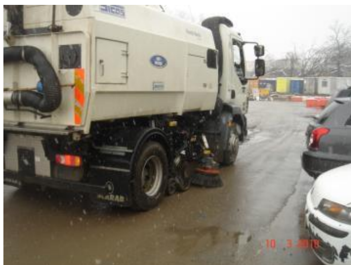
Figura 5-12 Pulizia di strade asfaltate con macchina spazzatrice
