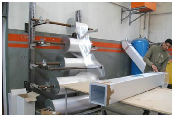
Figura 5-34: Sigillatura di ogni canale dopo verifica pulizia interna
