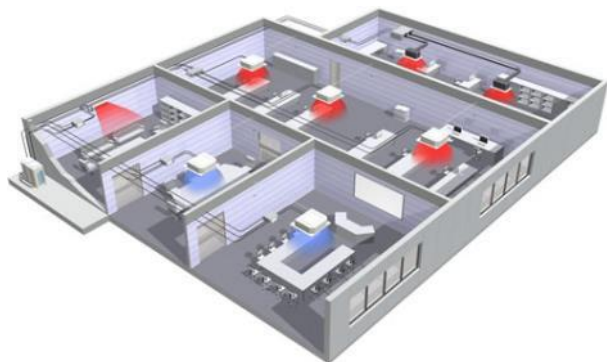
Figura 4-17 Schema di funzionamento sistema VRV
