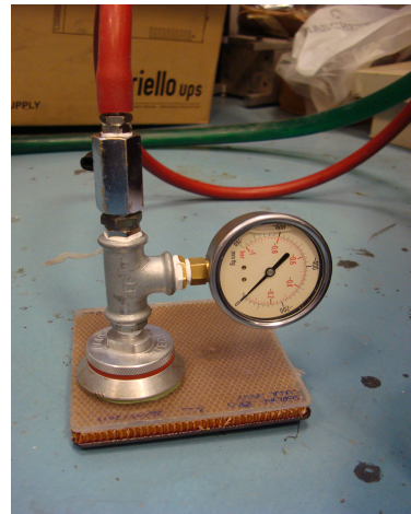
Figura 4.11: Dispositivo di verifica della tenuta della riparazione
