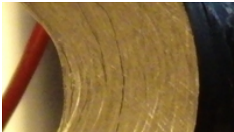
Figura 6.7. Delaminazione iniziale (lato sinistro) del primo provino angolare
