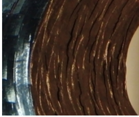
Figura 6.14. Lato destro del secondo provino angolare dopo il secondo danneggiamento
