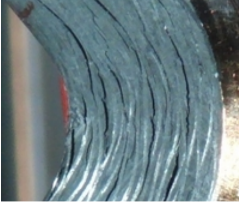
Figura 6.13. Lato sinistro del secondo provino angolare dopo il secondo danneggiamento
