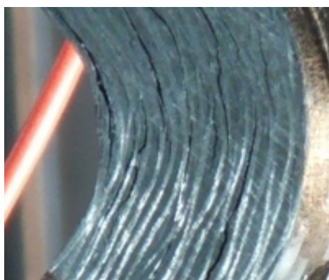
Figura 6.11. Delaminazione finale (lato sinistro) del primo provino angolare
