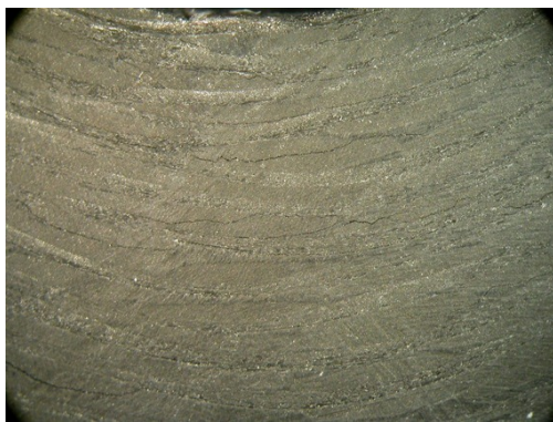
Figura 6.18. Delaminazioni multiple nel provino angolare senza binder (20x)
