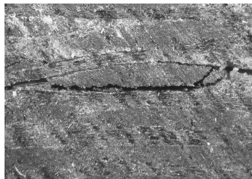
Figura 4.29. Comportamento della cricca nel provino ENF ad ingrandimento 50x
