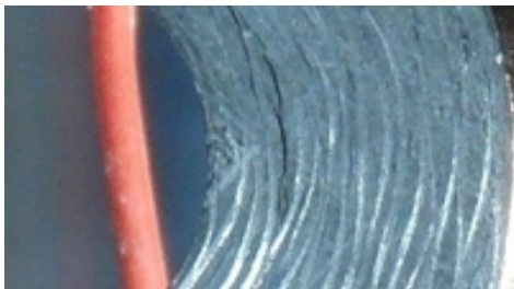
Figura 6.9. Delaminazione iniziale (lato sinistro) del secondo provino angolare
