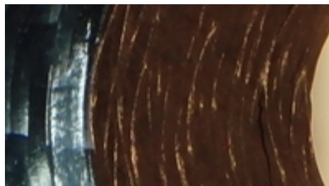
Figura 6.10. Delaminazione iniziale (lato destro) del secondo provino angolare
