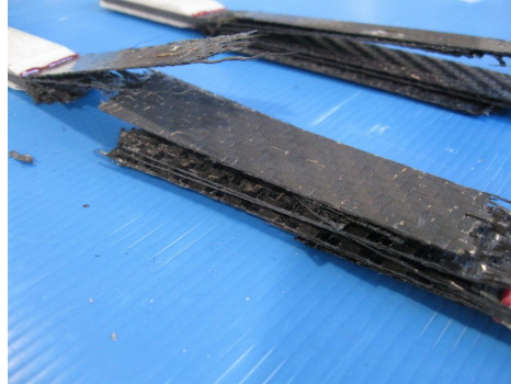
Figura 3.6. Delaminazione a trazione del provino
