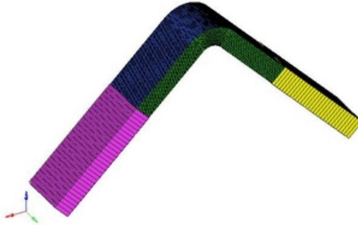
Figura 6.26. Mesh del provino angolare
