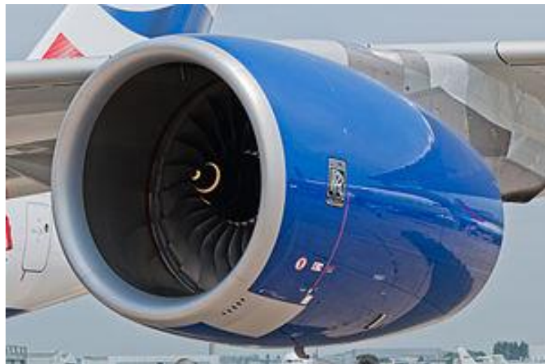
Figura 1.2: Motore RoyceTrent XWB-97 con scocca in materiale CFRP
