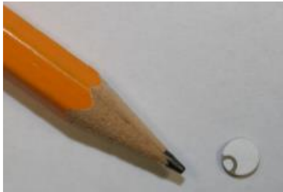
Figura 2.10: Trasduttore PZT PIC255 PiCeramic impiegati nelle prove di questa tesi
