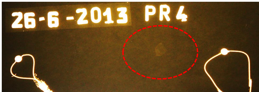
Figura 3.8: Radiografia laminato SAATI EH550/T800S con difetto da 8 mm
