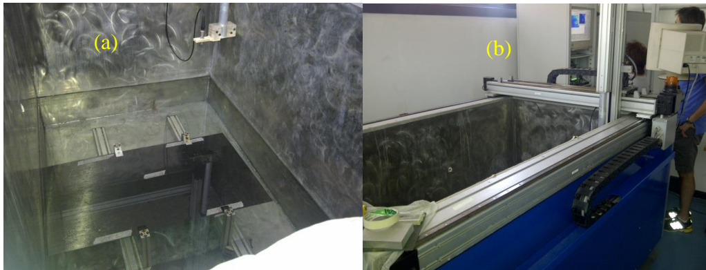
Figura 4.12: Apparecchiatura C-Scan del Dipartimento Aerospaziale del Politecnico di Milano: a) Interno vasca, in cui è presente la lastra impattata sospesa sull'apposita attrezzatura; b) sistema di movimentazione cartesiano su guide a ricircolo di sfere
