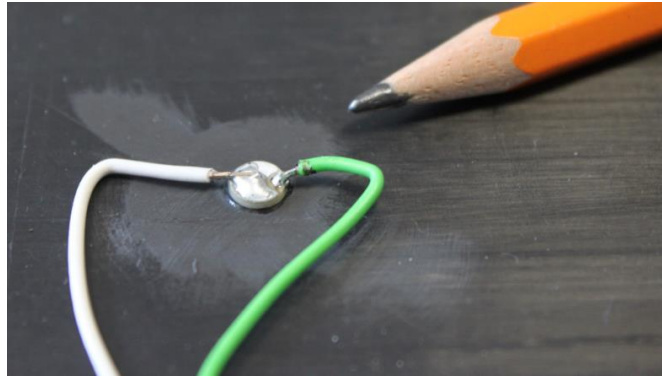
Figura 2.11: Particolare del PZT collegato e incollato sulla piastra SAATI EH550/T800S
