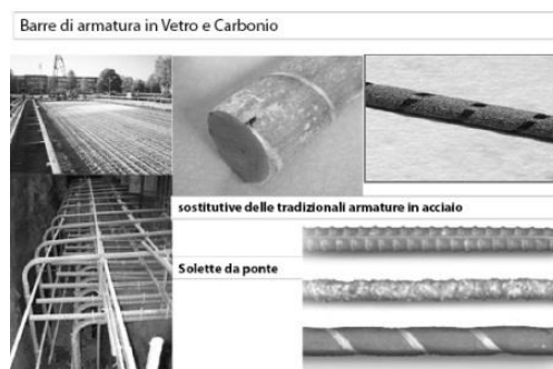
Figura 1.10: Tondini per cemento armato costruiti in fibra di vetro o CFRP
