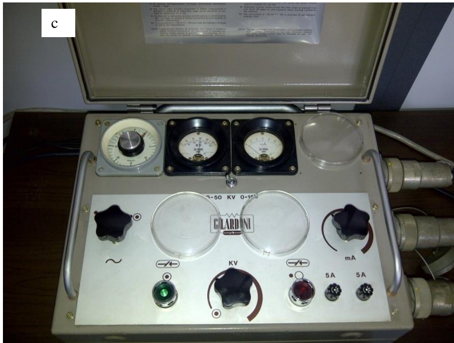
Figura 3.5: Macchina radiogena: a) bunker piombato per la protezione da fughe radioattive; b) tubo di Coolidge; c) Centralina di controllo
