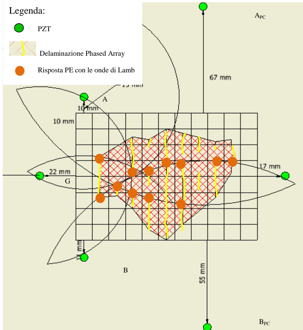
Figura 4.19: Mappatura ottenuta sul laminato SAATI EH550/T800S nella zona di delaminazione a 20 J in cui si confrontano i risultati del Phased Array con ciò che è stato ottenuto dalla triangolazione con le onde di Lamb
