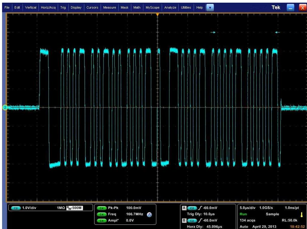
Figura 5.5 risultato acquisizione con  $G=1$  e  $OFF=1.75V$
