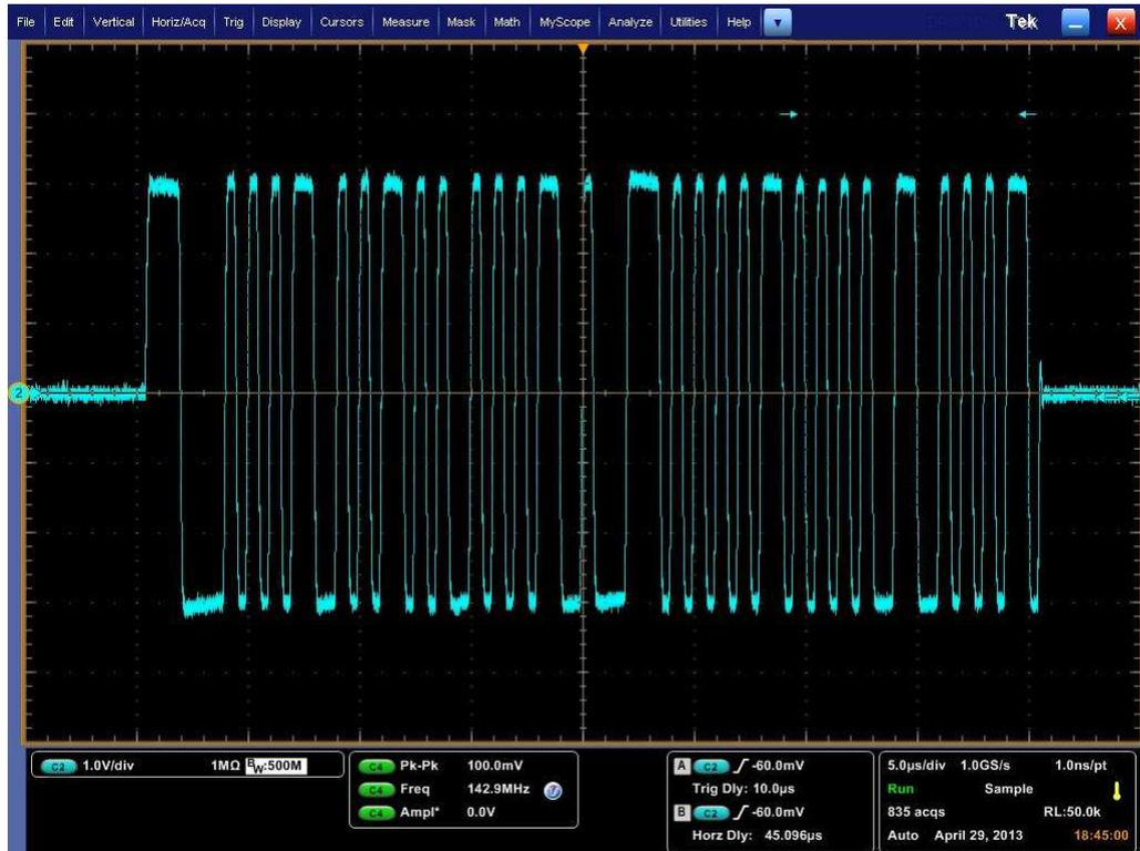
Figura 5.7 risultato acquisizione con  $G=4$  e  $OFF=1.75V$
