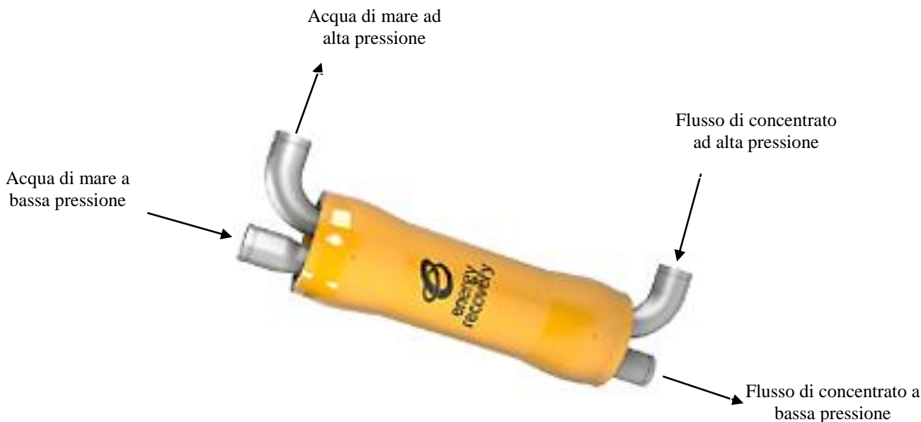
Figura 3.61. Immagine del PX con indicazione dei flussi (adapted from ERI product catalog). L'acqua di mare a bassa pressione è alimentata al Pressure Exchanger da una delle due porte della testata lato feed ed esce ad alta pressione dall'altra porta appartenente alla stessa testata. Viceversa il flusso di concentrato è alimentato ad elevata pressione ad una delle due porte della testata lato concentrato ed è scaricato a bassa pressione dall'altra porta.
