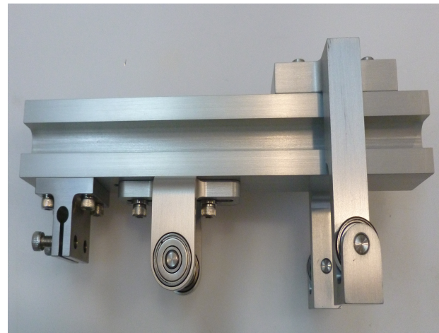
(d) Fixture for mixed mode I-II testing: mobile lever.
