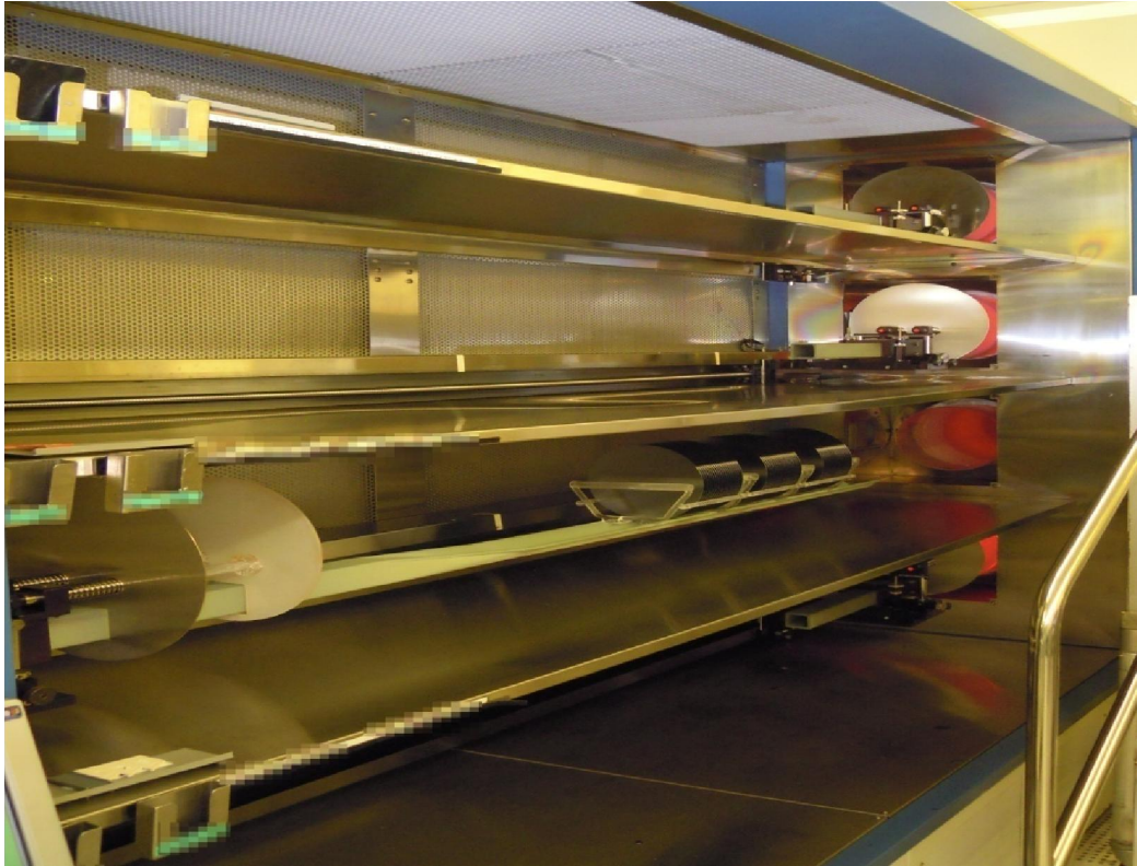
Figura 3.35. Forno per il processo di Annealing.
