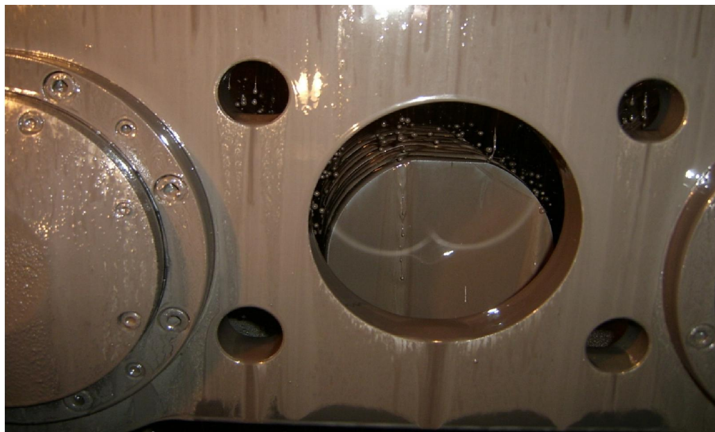
Figura 3.15. Wafers in una taglierina a filo con abrasivo.
