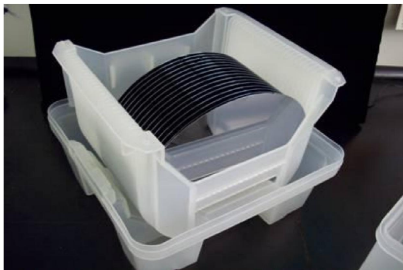
Figura 4.1. Wafers di silicio da 200mm.
