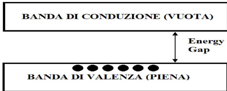
Figura 1.1. Schema delle bande di energia ad una temperatura pari a 0 K e in assenza di altre forme di energia.
