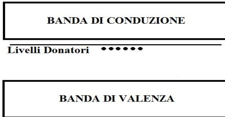
Figura 1.4. Schema delle bande di energia in un semiconduttore di tipo N.
