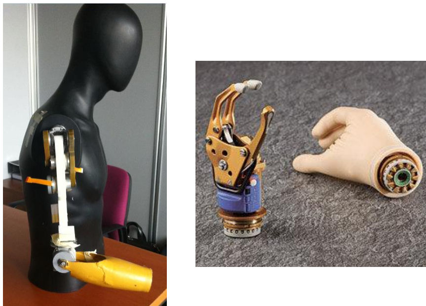
Figura 8: Protesi fisica di riferimento con relativo meccanismo mano
