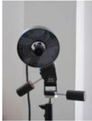
Figura 14: Telecamera del sistema SMART-e (BTS)
