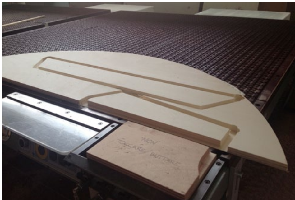
Fig. 91 Primi pezzi di prova tagliati con il pantografo
