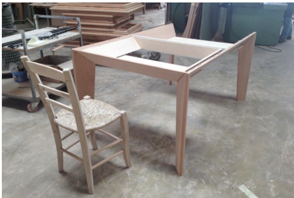
Fig. 93 Fase di assemblaggio del “castello” del tavolo con le gambe e gli elementi laterali
