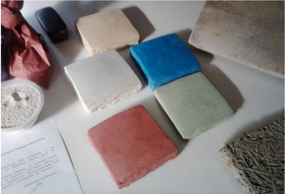
Fig. 96 Colorazioni di calce disponibile per le finiture in Tadelakt del tavolino Moldi
