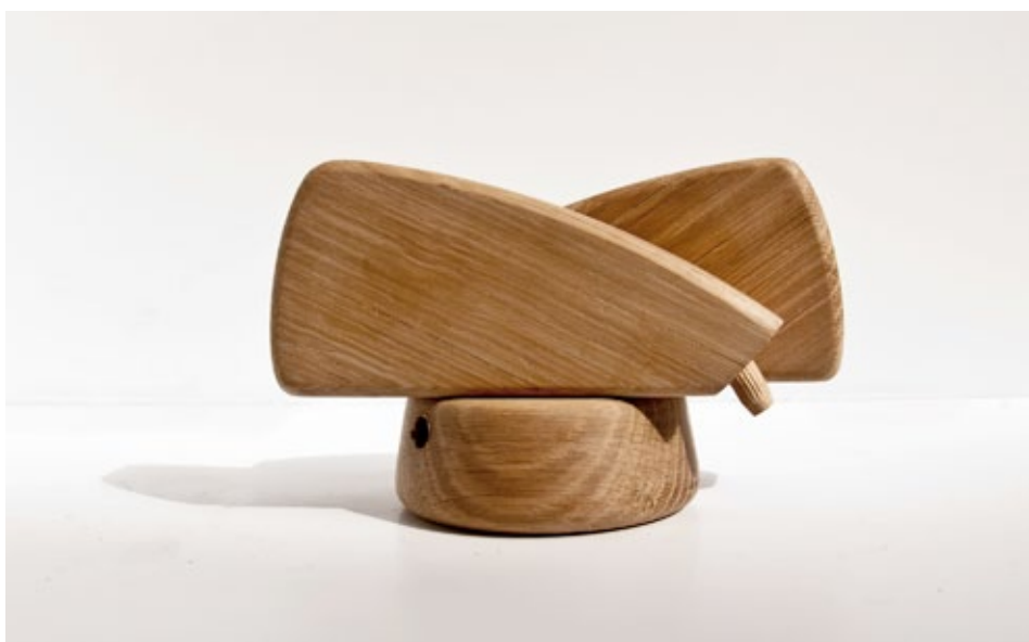
Fig. 66 Particolare dei Galletti in fase di costruzione con gli elementi ancora da spinare
