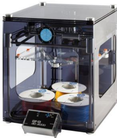
Figura 14: Stampante 3D utilizzata per la realizzazione degli scaffold in PLA
