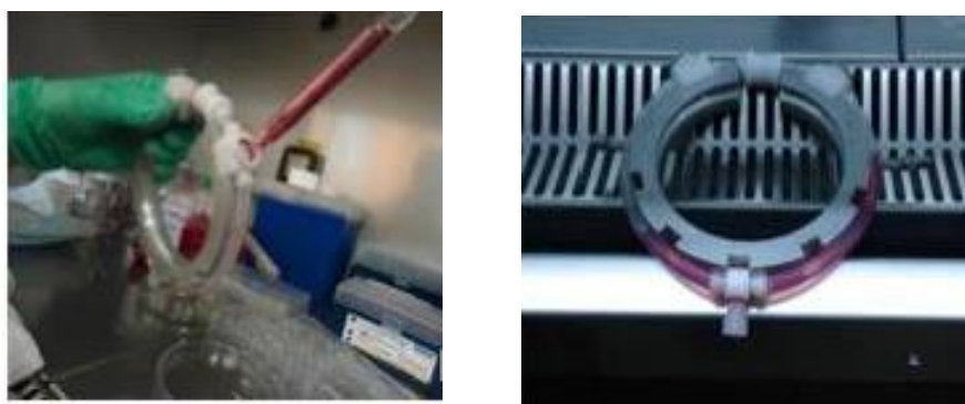
Figura 24: A destra un'immagine della fase di riempimento della camera di coltura, a sinistra la camera di coltura pronta per essere inserita nell'incubatore.
