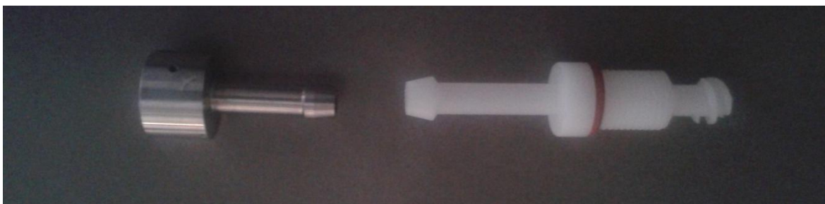
Fig.7 - A sinistra è raffigurato l'afferraggio distale ed il particolare del foro responsabile della perdita di carico e a destra l'afferraggio prossimale con il filetto che permette il fissaggio al coperchio della camera e il collegamento per il tubo del circuito idraulico
