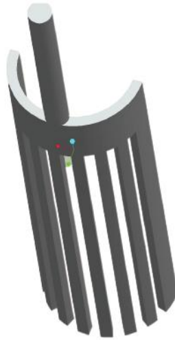
Fig.25 - Rappresentazione della nuova geometria studiata per il dissipatore di calore
