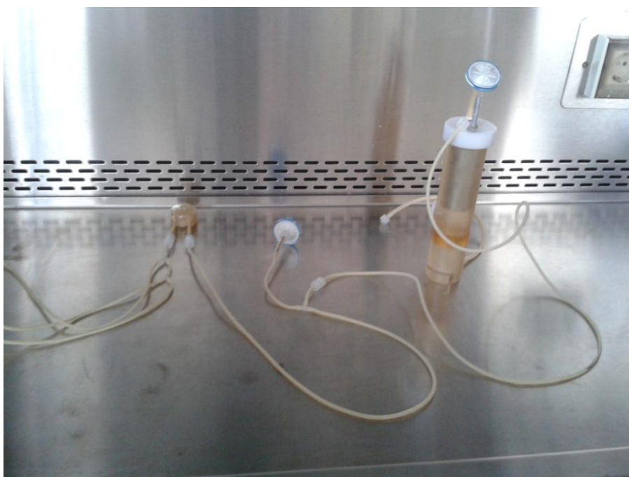
Fig.29 - Circuito idraulico durante il montaggio sotto cappa
