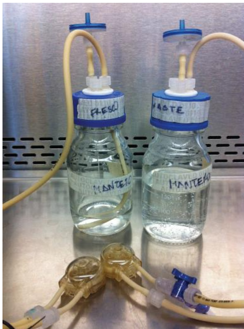
Fig.8 - Circuito idraulico realizzato nel precedente lavoro di tesi caratterizzato da un'unica linea idraulica per il riempimento e per lo svuotamento
