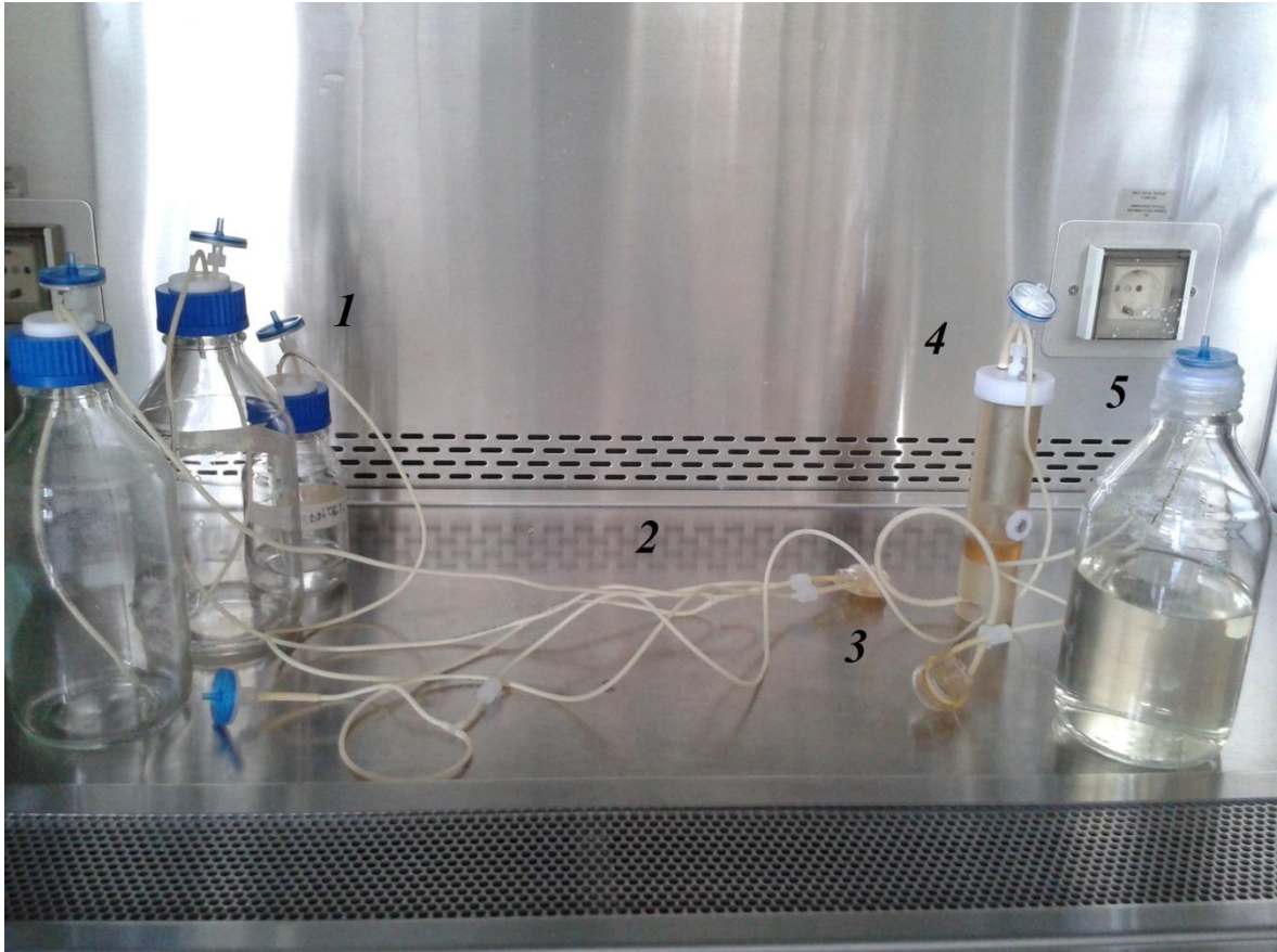
Fig.12 - Circuito idraulico completo costituito dai reservoir (1) in Pyrex®, dai tubi (2) Pharmed BPT®, dalle pompe (3), dalla camera di decellularizzazione (4) e il waste (5).
