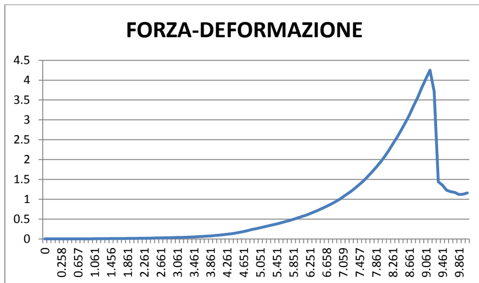
Fig. 35 - Grafico dell'andamento sforzo- deformazione ottenuto durante la prova a rottura
