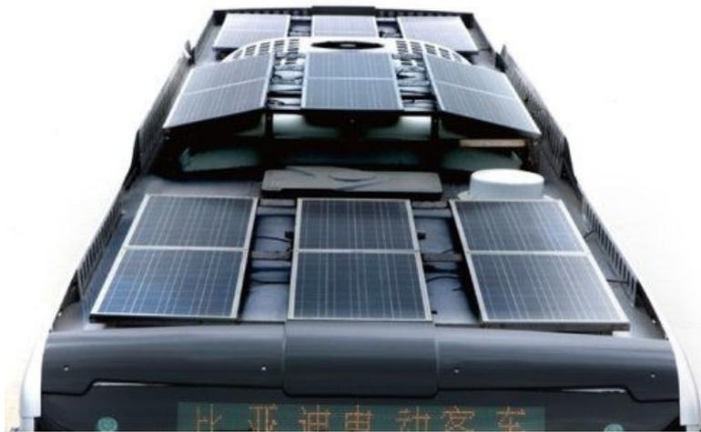
Figura 27: Sistema di moduli fotovoltaici sulla copertura del BYD K9.
