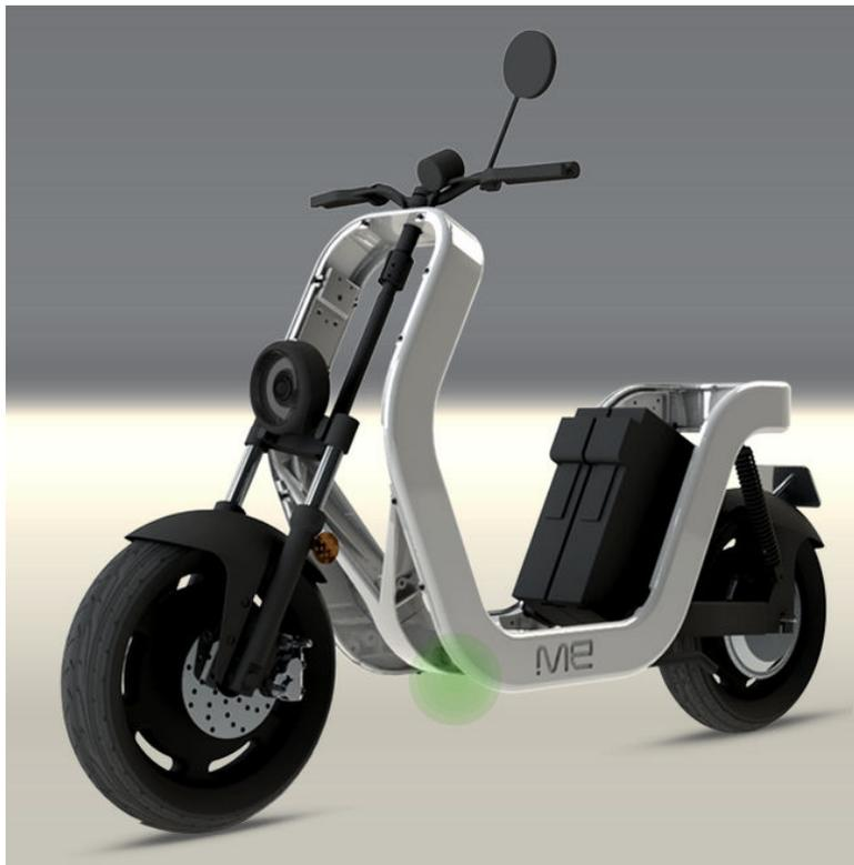
Figura 11: Struttura del telaio in SMC del ME di MotoriniZanini.
