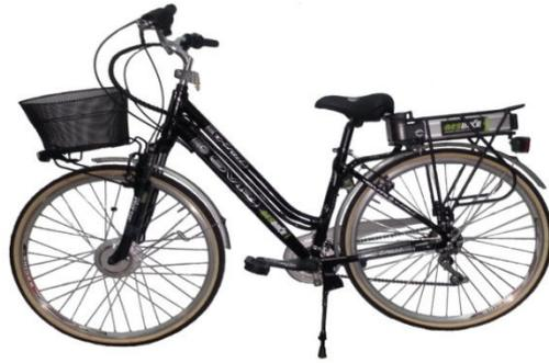
Figura 3: Bicicletta elettrica con batterie poste sul portapacchi.
