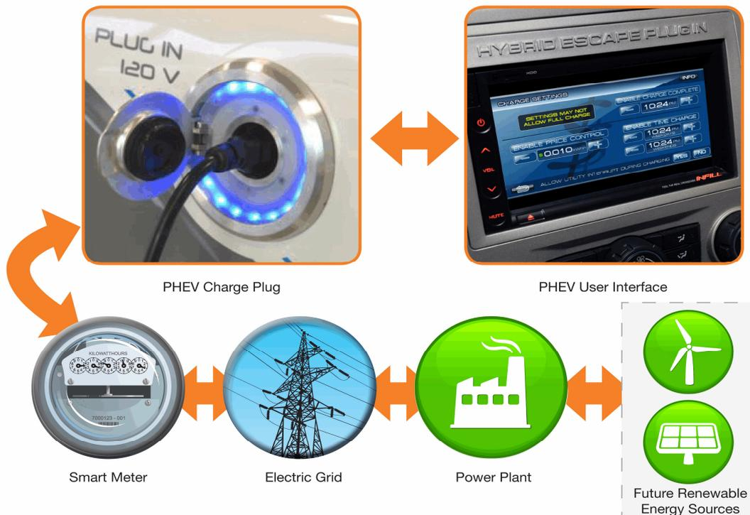
Figura 88: Schema di interazione tra rete e veicolo in un sistema Vehicle to Grid.
