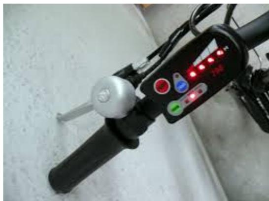
Figura 7: Display indica tante lo stato di carica della batteria.
