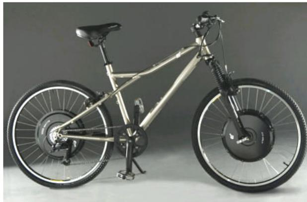
Figura 6: Coppia di motori posti su entrambi i mozzi delle ruote.
