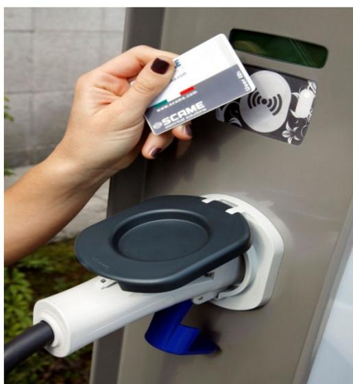
Figura 71: Procedura di rilascio del cavo di ricarica utilizzando la RFID Card personale.
