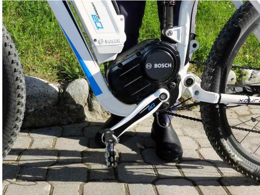
Figura 5: Motore posto nella parte inferiore del telaio.
