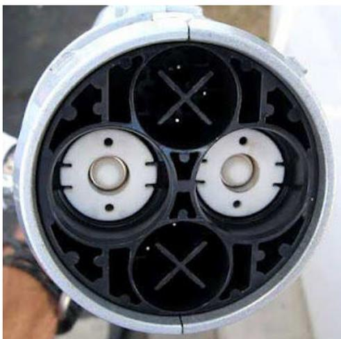
Figura 55: Connettore tipo CHAdeMO.
