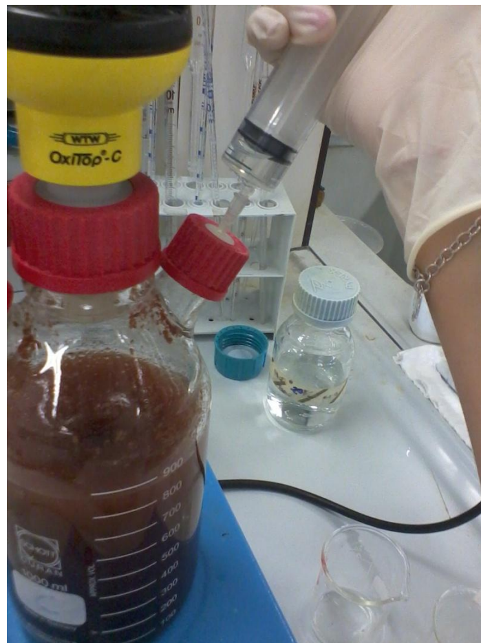
Figura 3.10 Particolare dello spike in bottiglia OxiTop
