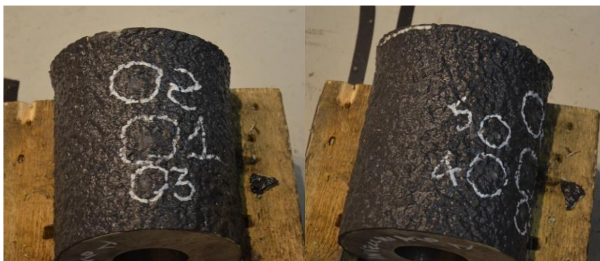
Figura 2.16 Impronta danno con energia di impatto a 12J(a) energia di impatto 32J(b)
