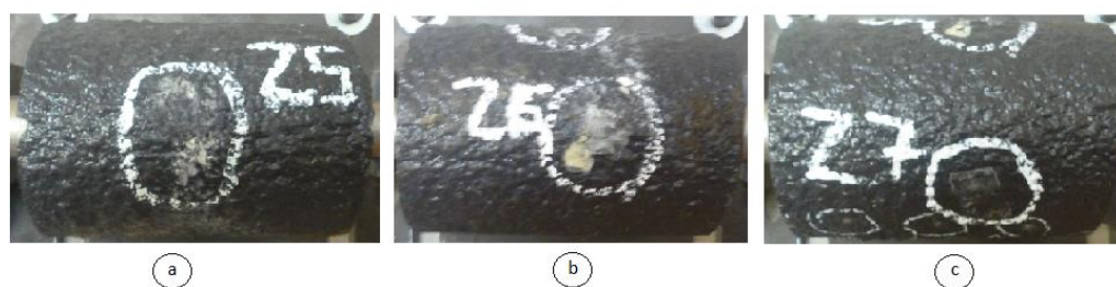
Figura 2.35 Impronte su assile con rivestimento nuovo
