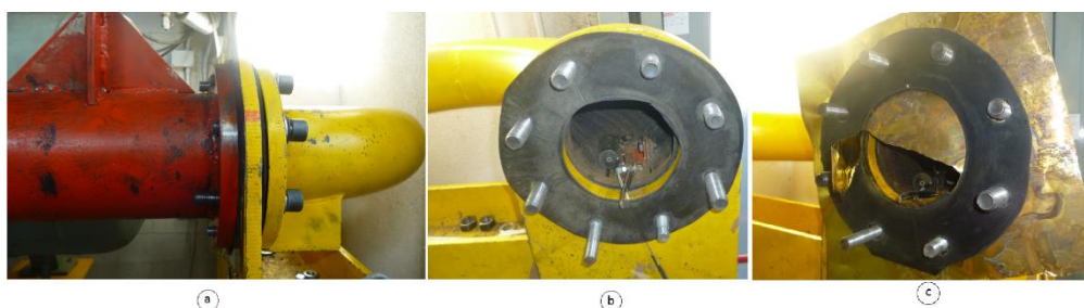
Figura 2.24 Meccanismo di sparo. (a) raccordo bullonato alla flangia (b) meccanismo di sparo (c) membrana rotta dopo sparo
