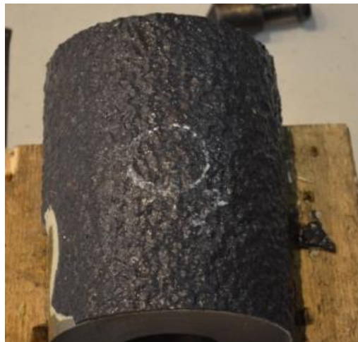
Figura 2.17 Impatto a E=12J temperatura controllata T=-25
