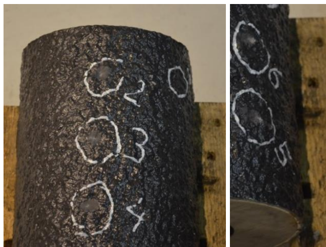
Figura 2.15 Impronta su troncone rivestito con Lursak :E=32J(a),E=32J angolo inclinazione 45°(b)
