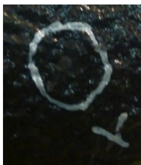
Figura 2.14 Impronta su troncone rivestito con Lursak a E=12J
