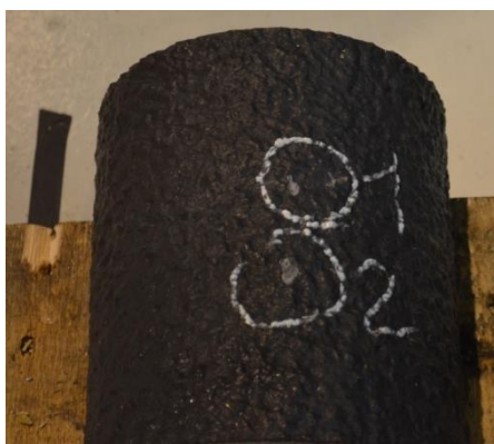
Figura 2.20 Impronta con prova a T=-25^{\circ}\text{C} assile invecchiato, impatto a 45^{\circ} , E=32\text{J}
