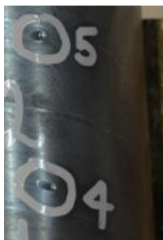
Figura 2.11 Impatti a E=12 J angolo di impatto 45°
