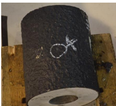
Figura 2.21 Impronta con prova a T=-25^{\circ}\text{C} assile invecchiato, E=12\text{J}
