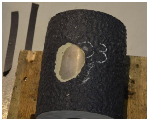
Figura 2.19 Impronta con prova a T=-25^{\circ}\text{C} assile invecchiato
