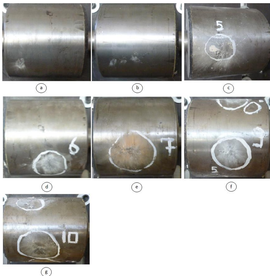
Figura 2.32 Impronte su assile non rivestito
