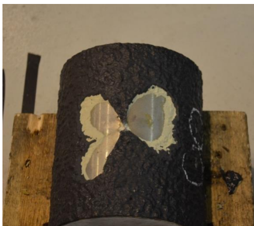
Figura 2.22 Impronta con prova a T=-25^{\circ}\text{C} assile invecchiato, E=32\text{J}
