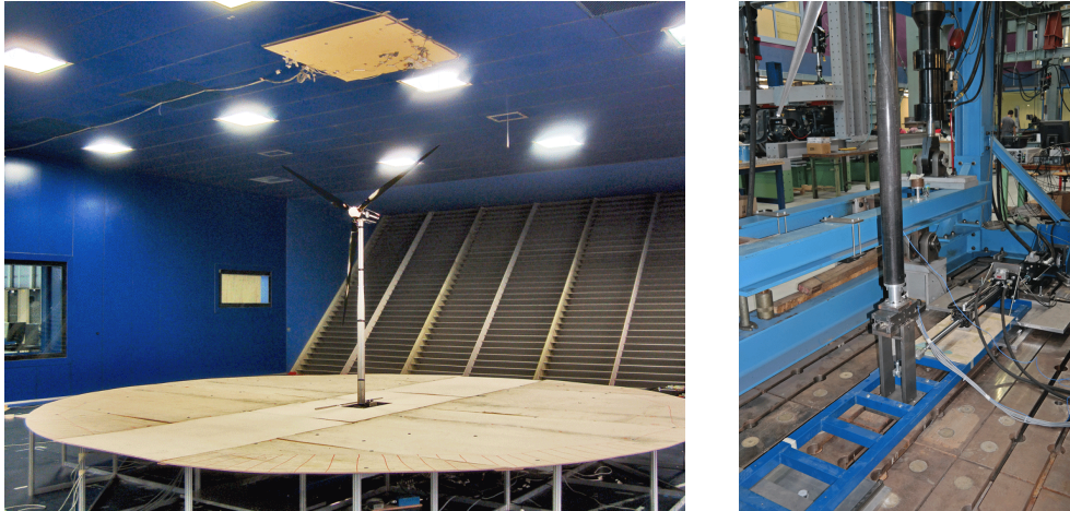
Fig. 1.23: Attuale set-up sperimentale a 2-gdl per la movimentazione dei modelli di generatori eolici, per gentile concessione dell'ing. Ilmas Bayati.
