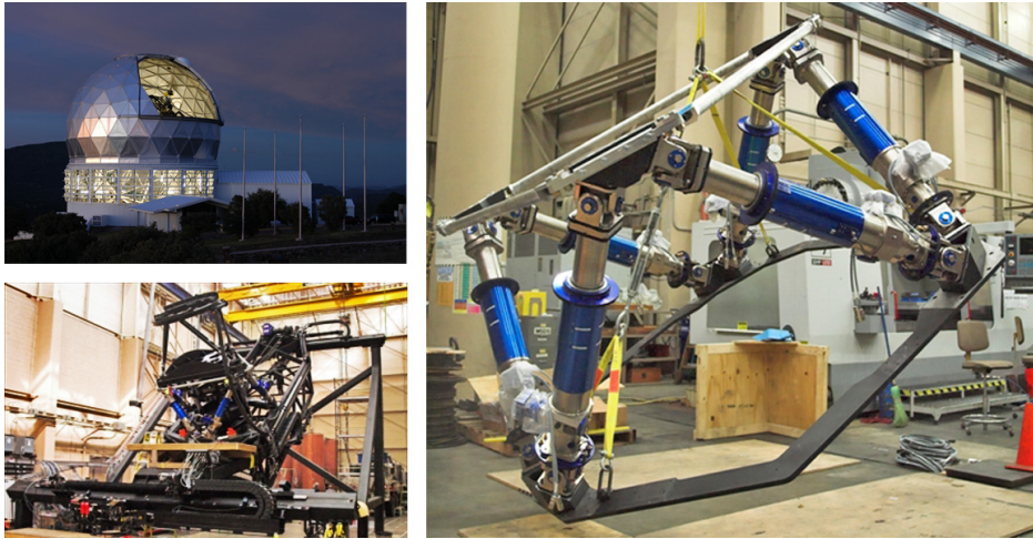
Fig. 1.15: Esapode di ADS Int. per l'Hobby-Eberly Telescope (HET, Texas).
