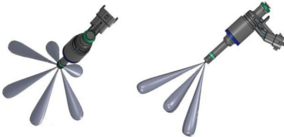
Figura 6.9: Iniettore Bosch a sei fori
