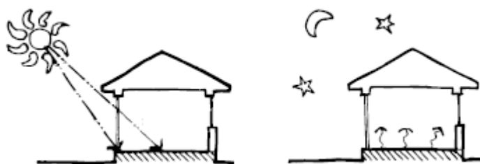
Figura 10: comportamento invernale della massa termica dell'edificio
