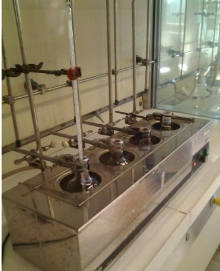
Fig. 14 Posizionamento delle ampolle all'interno dello strumento precedentemente riempito con acqua deionizzata.
