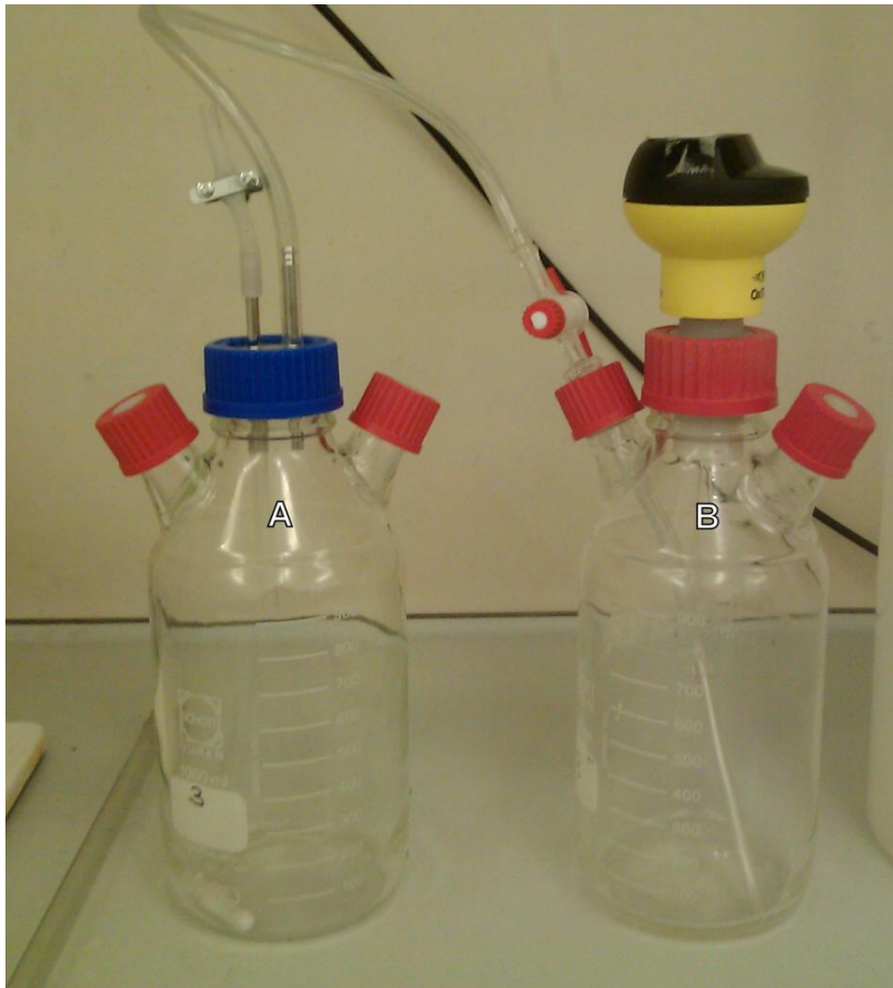
Fig. 15 Configurazione reattori oxiTop.
