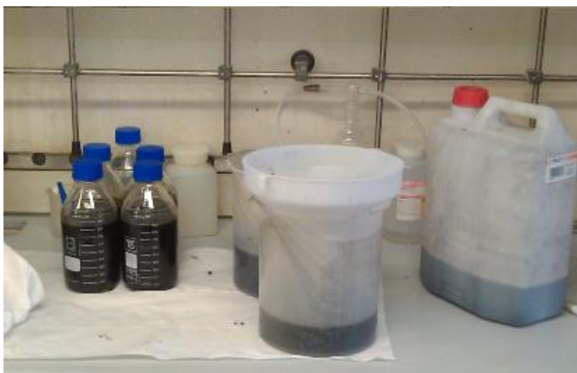
Fig. 12 Operazioni preliminari di gestione del digestato anaerobico prelevato a Peschiera Borromeo.
