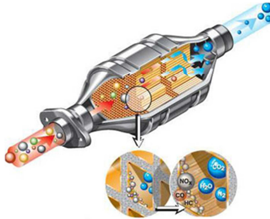
Figura 1.7: Schema di una marmitta catalitica
