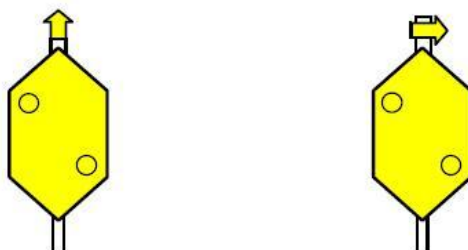
Figura 4-7: Segnali di avviso di rallentamento con freccia indicatrice del binario interessato.
