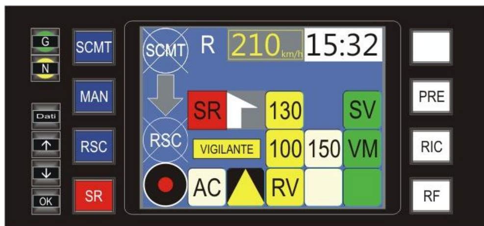
Figura 4-26: Esempio di schermata del sottosistema di bordo del SCMT.
