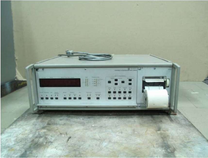
Immagine i 5.4 : Fotografia della cabina centrale di acquisizione dati UPM 60.
