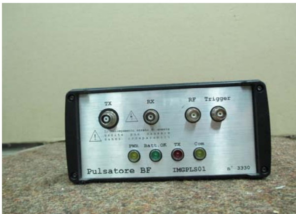
Immagine i 5.7 : Pulsatore BF IMGPLS 01 e Campionatore Picoscope.
