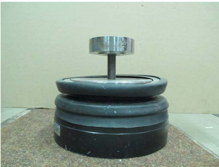
Immagine i 5.2 : Fotografia del particolare piatto articolato della macchina Schenck.
