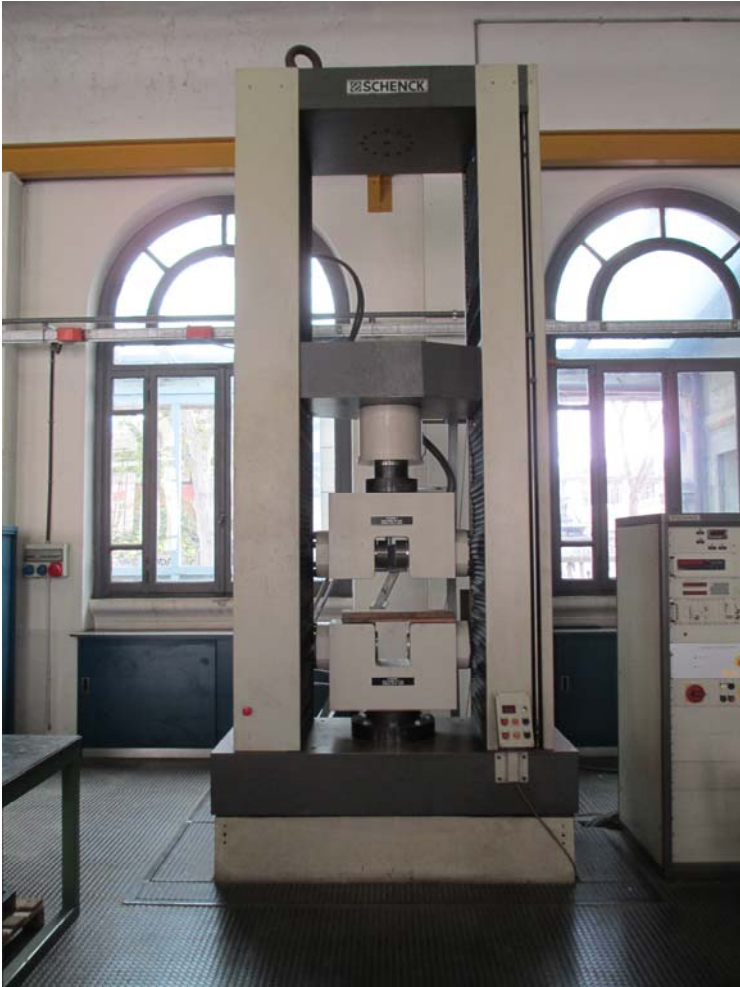
Immagine i 5.1 : Fotografia della macchina Schenck utilizzata per le prove di compressione.
