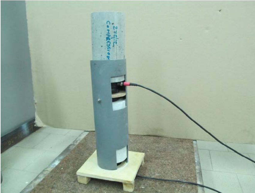
Immagine i 5.9 : Insieme emettitore-provino-ricevitore-peso di 3.77 kg (posizionato in alto).
