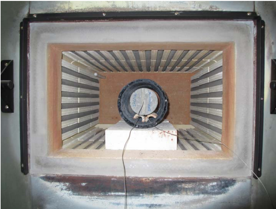
Immagine i 5.6 : Fotografia della strumentazione per le prove di diffusività.
