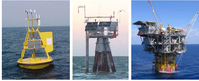
Figura 3.2: Tre esempi di boe fisse: a sinistra una boa ancorata, al centro un rilevatore meteorologico nei pressi della costa e a destra una struttura estrattiva
