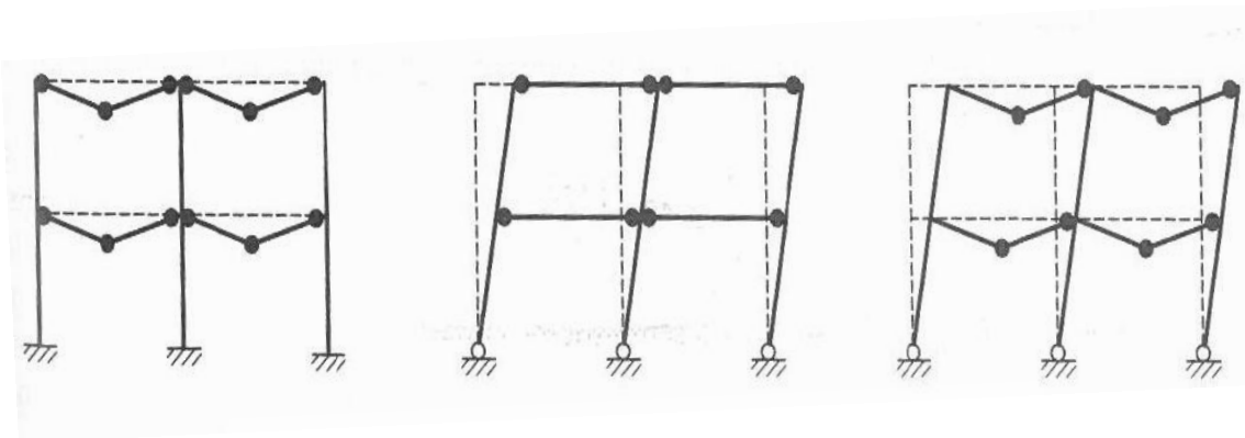
Figura 5.2.8 Tipici meccanismi di collasso per telai in acciaio
