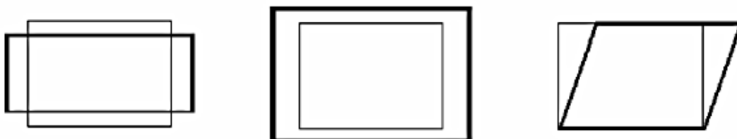
Figura 4.2.4 Tre modi di deformazione reale relativi all'elemento membranale piano a 4 nodi
