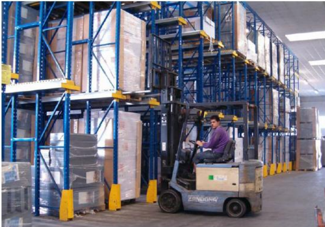
Figura 6.3.1 Carrello elevatore operante tra le scaffalature
