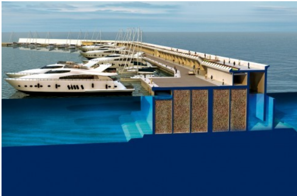
Figura 4.31. Sezione del progetto d'implementazione del convertitore Rewec3 nella barriera frangiflutti del porto di Civitavecchia
