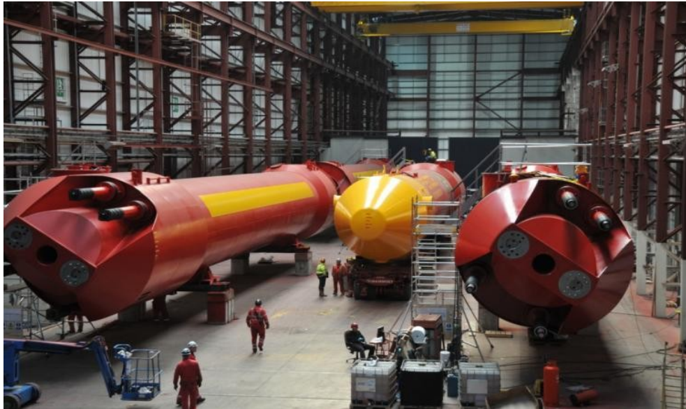
Figura 4.5. Componenti della macchina Pelamis P2 durante le operazioni di manutenzione. Fonte Pelamis Wave Power
