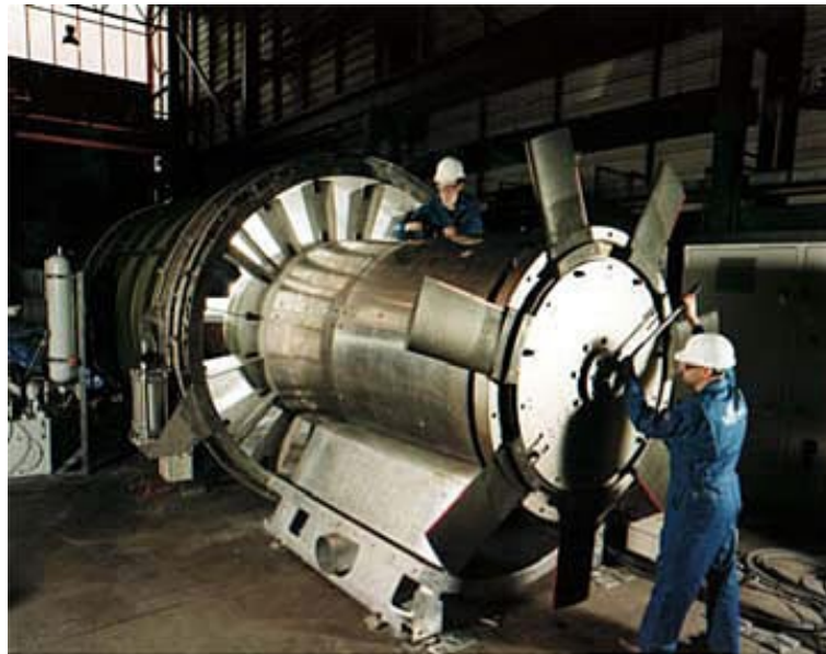
Figura 3.21. Turbina Wells dell'impianto OWC a Mutriki in Spagna
