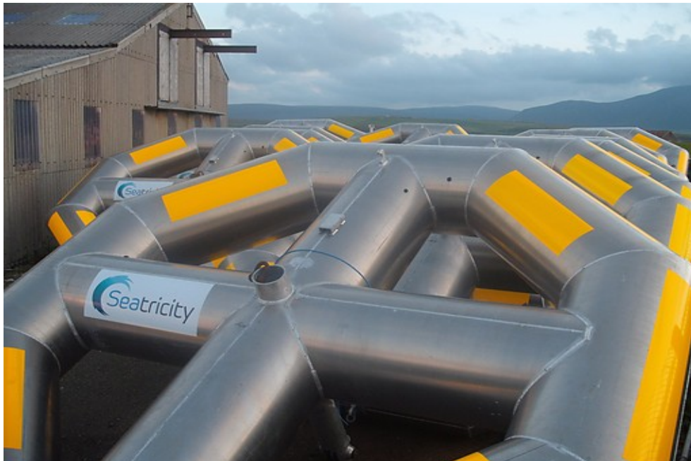
Figura 4.15. Componenti calleggianti dei dispositivi Seatricity
