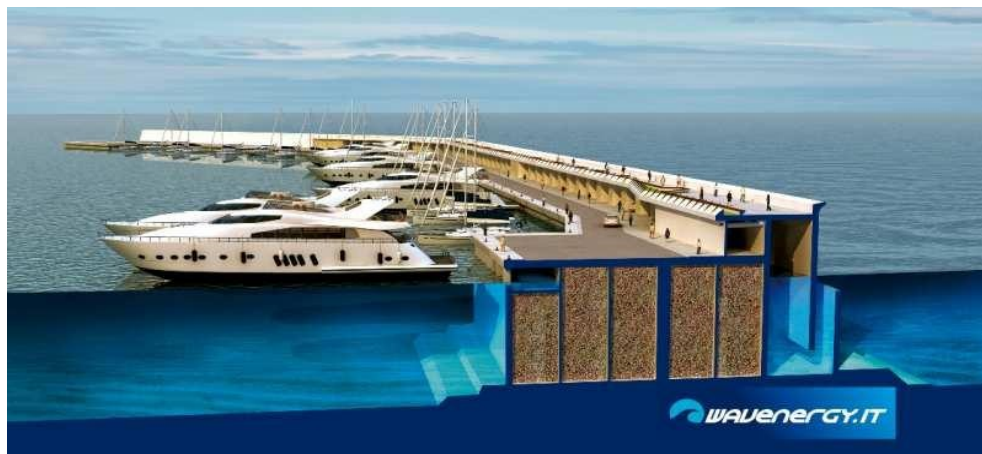
Figura 5.25. Rappresentazione tridimensionale della sezione del cassone REWEC3 all'interno della diga di sopraflutto del Marina di Cicerone. Fonte avenergy.it
