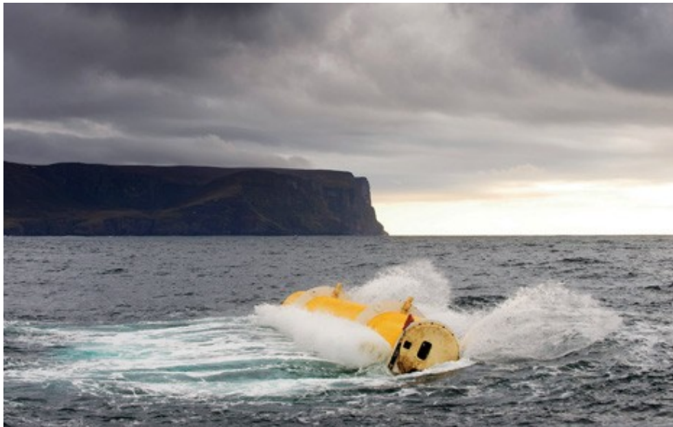
Figura 4.3. Vista marina dell'Oyster in funzione all'EMEC
