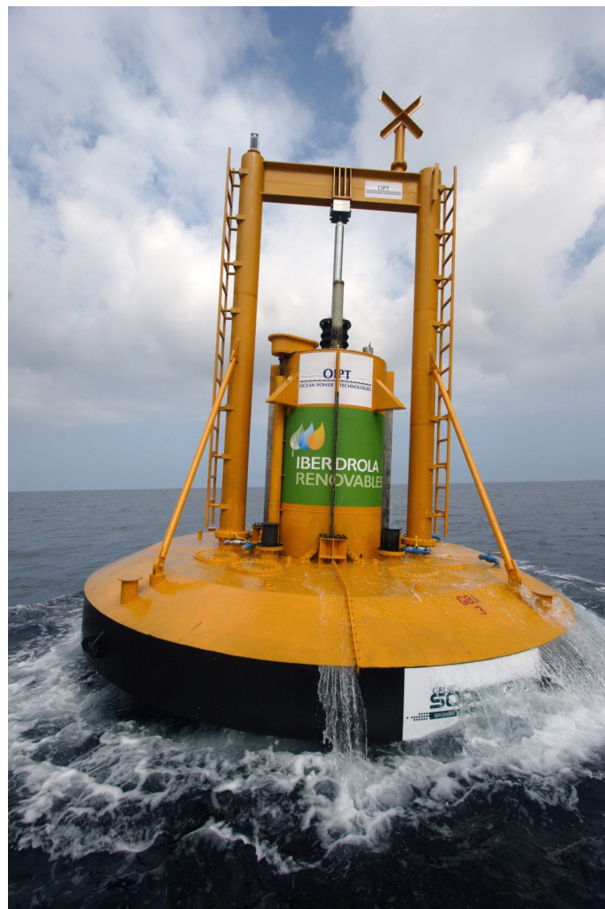
Figura 4.18. Power buoy Mark 3 impiegato nel sito di Santona
