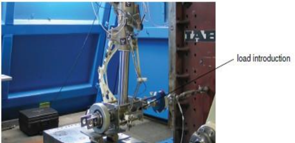
Figura 16 - Prove di rigidezza: Configurazione carico +Y
