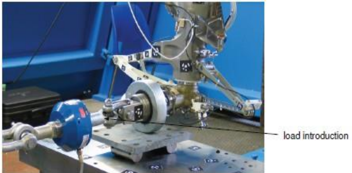
Figura 17 - Prove di rigidezza: Configurazione carico -Y
