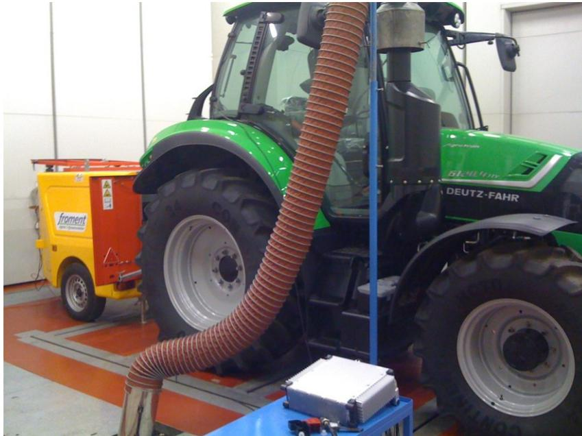
Figura 5.6 Agrottron 6120.4 TTV con freno idraulico durante prova 100% sotto carico.
