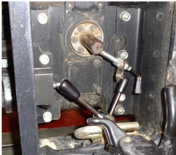
Figura 5.4 Sensore magnetico sulla p.t.o posteriore.
