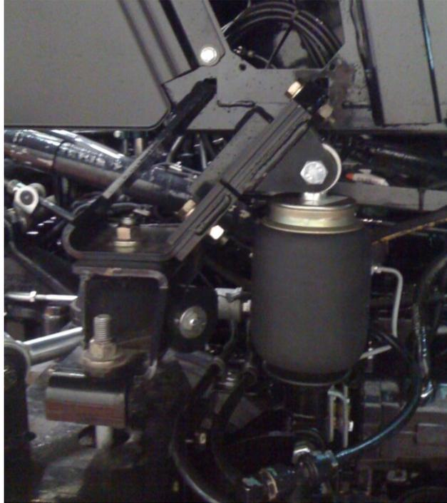
Figura 3.11 Sospensione posteriore ad aria.
