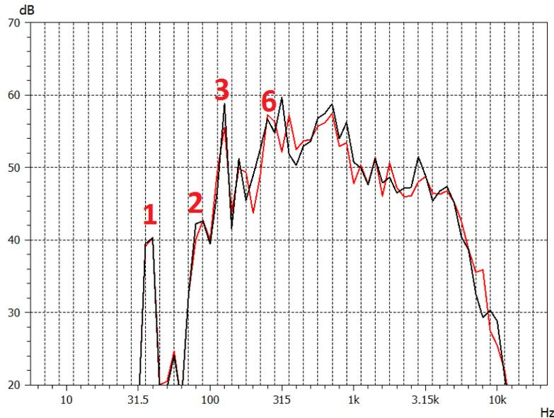
Figura 6.2 Ordini motore 1,2,3 e 6 e rispettivo valore Spl in dB(A) in sestì d'ottava di una trattrice con motore 6 cilindri al massimo regime, pari a 2300 rpm.
