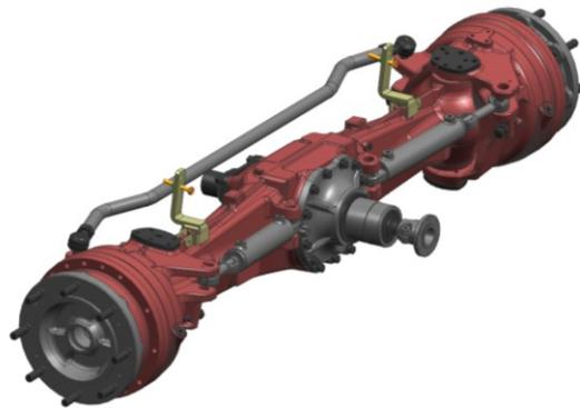
Figura 3.3 Ponte anteriore cad {1}.
