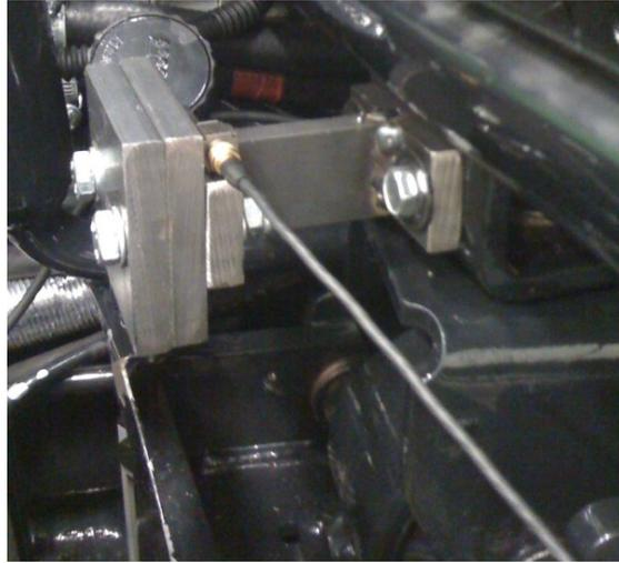
Figura 7.22 Mass damper sinistro in configurazione definitiva.
