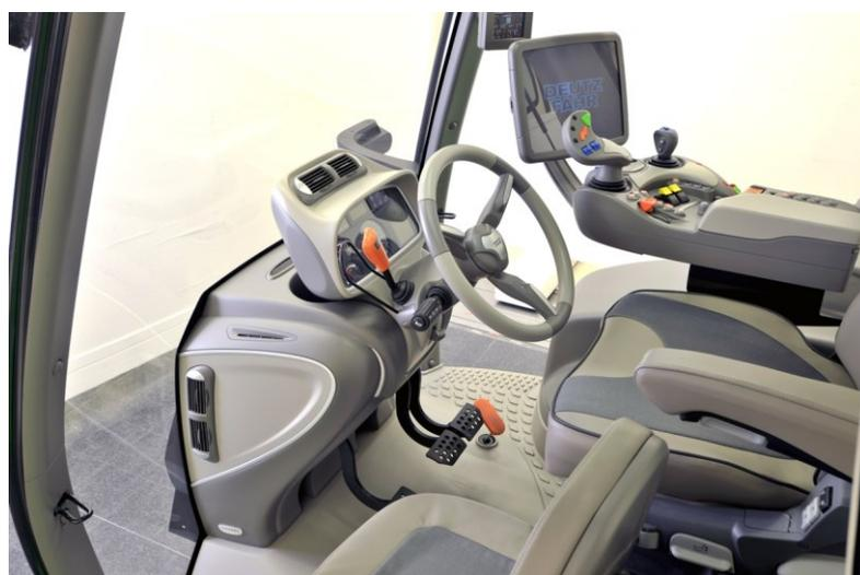
Figura 3.13 Cabina Deutz-Fahr per modelli di fascia medio-alta {1}.
