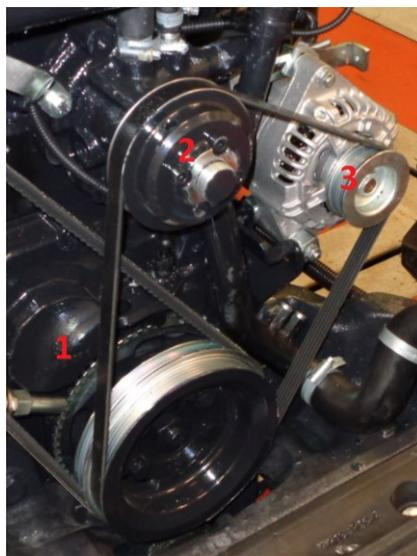
Figura 5.2 Ruota dentata e sensore per giri motore (1), pompa acqua con attacco ventola viscostatica (2), alternatore (3)
