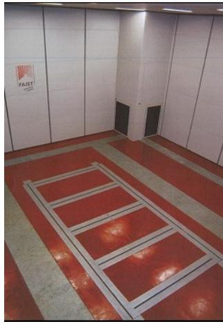
Figura 5.1 Camera semi-anechoica.
