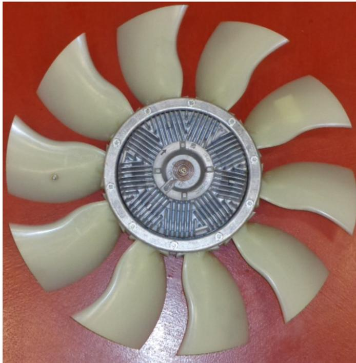
Figura 3.10 Ventola con giunto viscostatico bimetallico.
