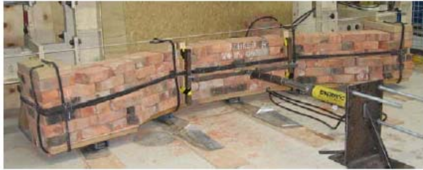
Figura 7.52 Test out of plane : muro viene spinto contro i suoi appoggi.
