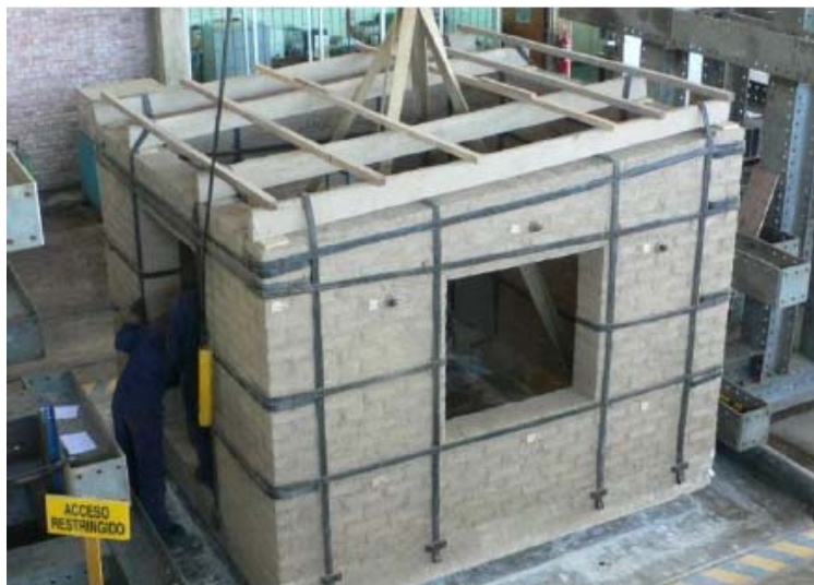
Figura 7.53 Il modulo mentre viene posizionato sulla shaking table .
