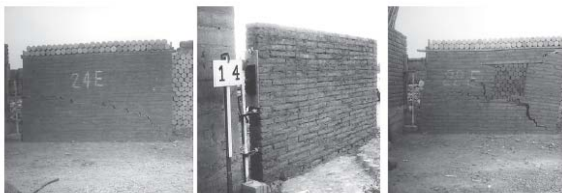
Figura 7.6 Muri di Adobe per test statici a taglio [Blondet e Vargas 1978].
