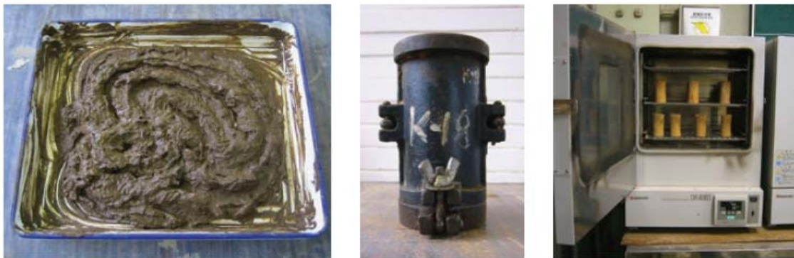
Figura 7.31 Preparazione della miscela, stampo dei provini e forno per l'essiccamento.
