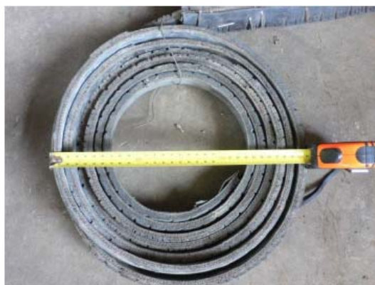
Figura 7.44 Una striscia di pneumatico di circa 6 metri pronta per essere installata.
