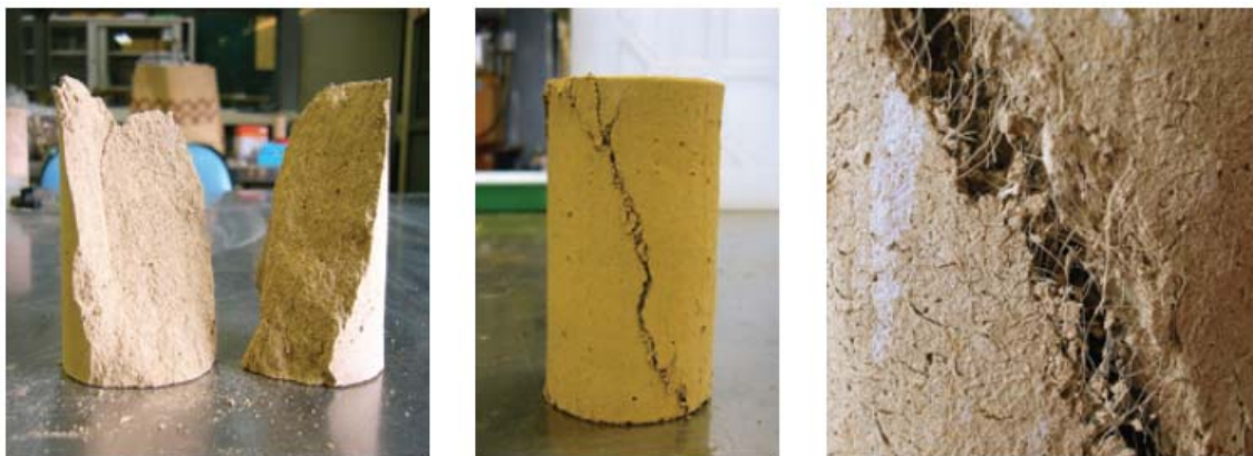
Figura 7.33 Modo di rottura dell'Adobe non rinforzato nella prima immagine a sinistra, rinforzato con la juta nelle rimanenti: nel dettaglio è evidente la funzione legante della juta.
