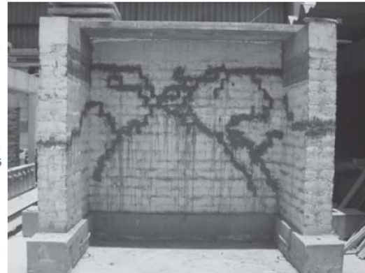
Figura 7.11 Risposta carico-spostamento (curve isteretiche) e panorama fessurativo Wall I-3 alla fine della prova.
