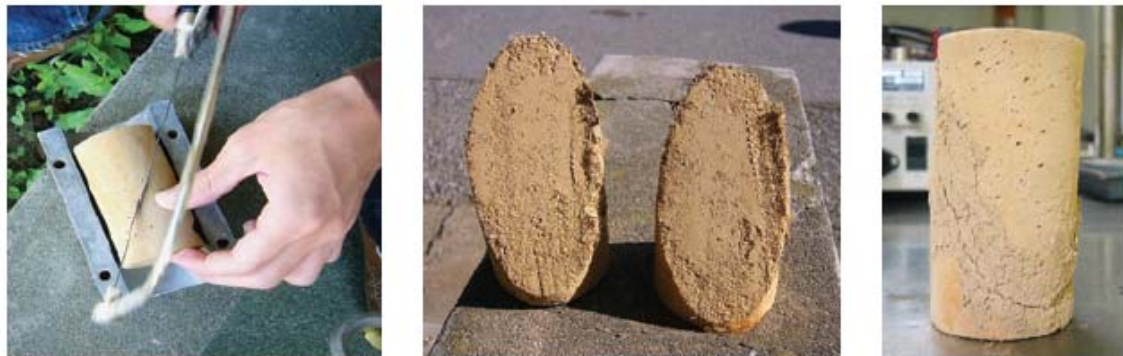
Figura 7.36 Realizzazione dei "provini sandwich": taglio a 60^\circ sull'orizzontale, le due parti dopo il taglio, il "provino sandwich" a compimento.
