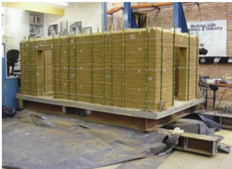
Figura 6.3 Armature esterne di canne di bamboo o di Guayaquil.
