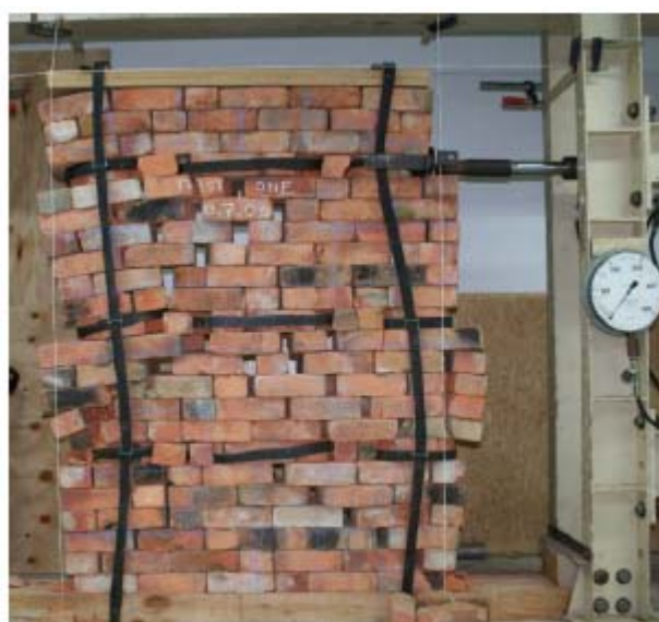
Figura 7.50 Provino dopo un ciclo completo.
