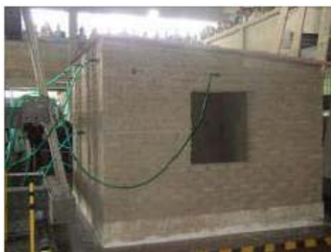
Figura 7.15 Modulo di Adobe dopo la fase 1.
