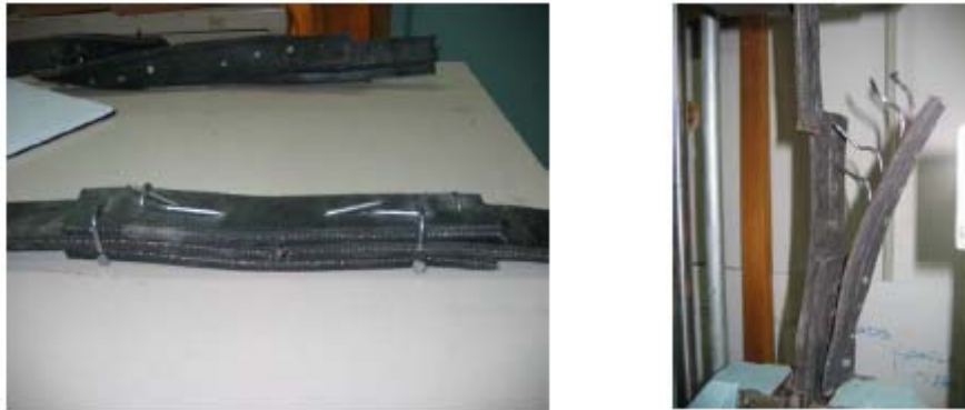
Figura 7.49 Collegamento completo con chiodi: sono piegati per prevenire la loro espulsione prematura, a destra la connessione al collasso con i chiodi espulsi.
