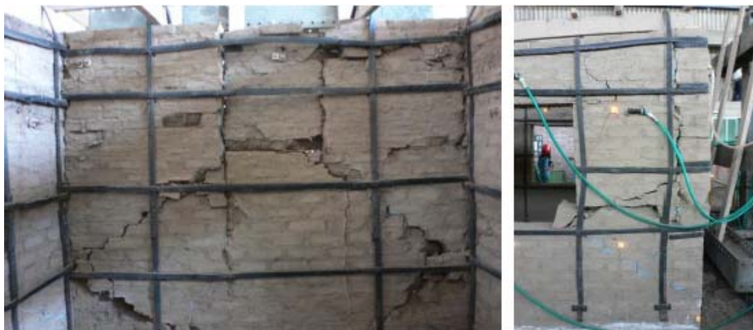
Figura 8.35 Risultati di test dinamici su un prototipo rinforzato con strisce di pneumatici usati.
