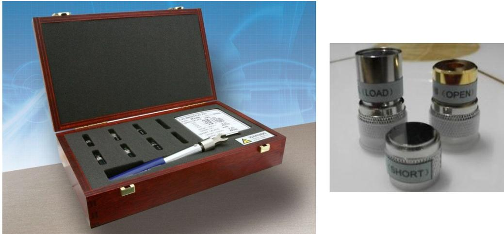
Figura 3.11 - Strumenti di calibrazione dell'analizzatore di rete
