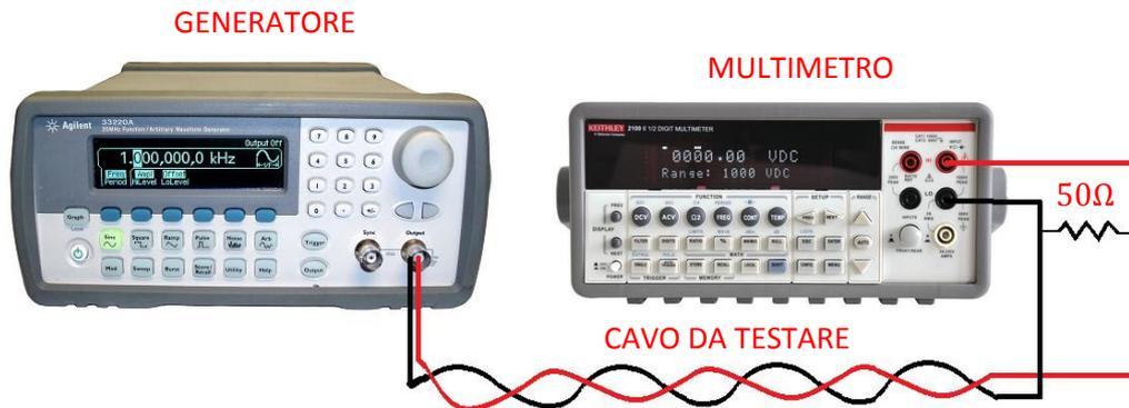
Figura 3.18 - Setup di misura dell'attenuazione a bassa frequenza
