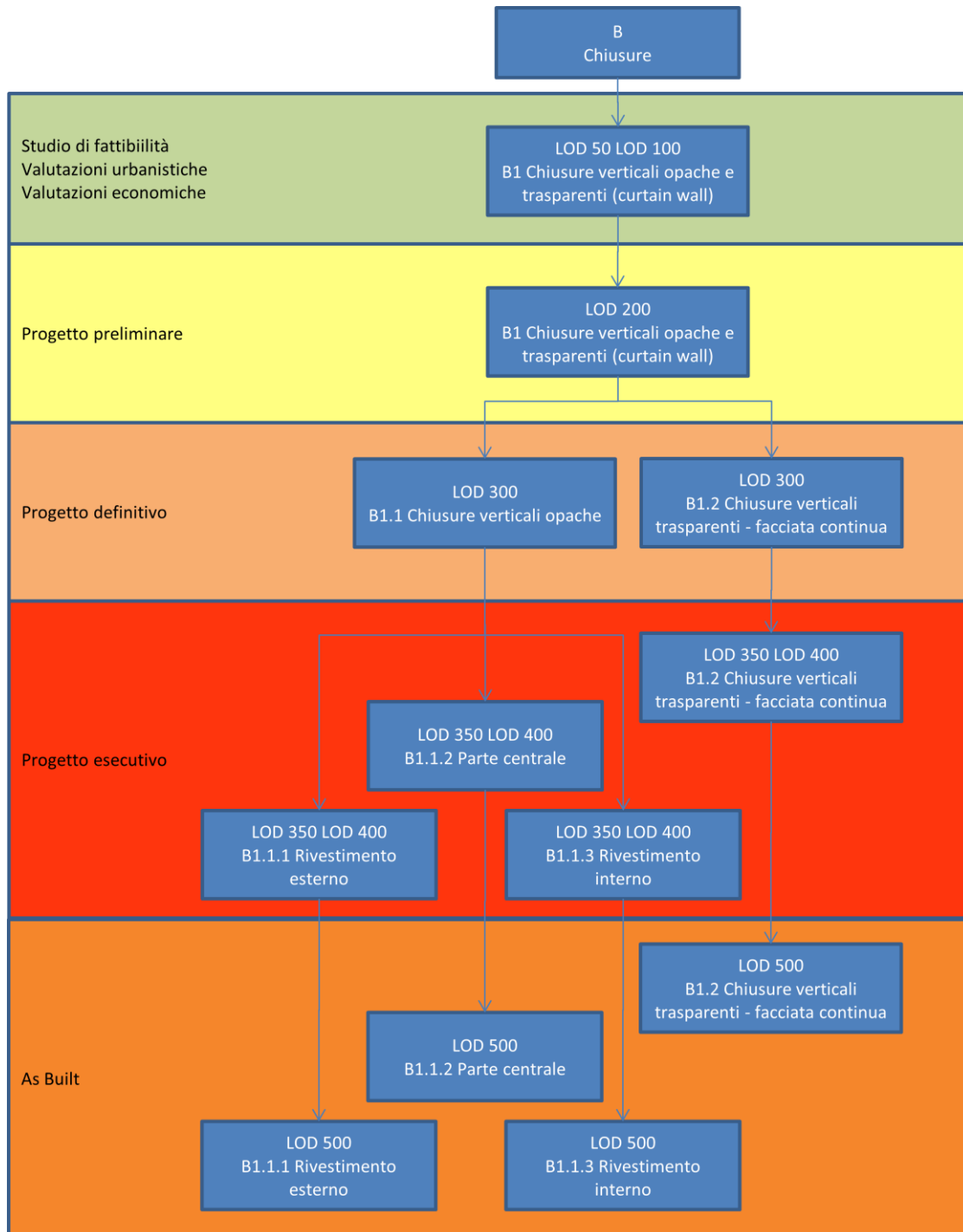
Figura 11: Diagramma di flusso LOD chiusure verticali opache e trasparenti
