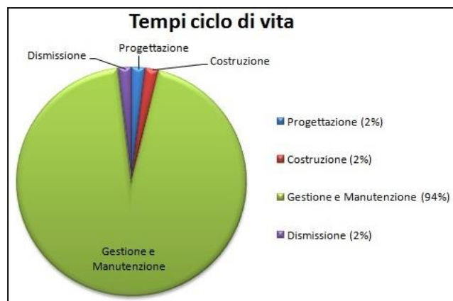
Figura 21: Proporzione della durata delle fasi di Progettazione, Costruzione, Gestione e Manutenzione e Dismissione
