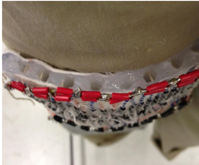
Fig. 5.28 Particolare dell'attuatore: in vista la sezione cava con cui è stato ottenuto l'alleggerimento.
