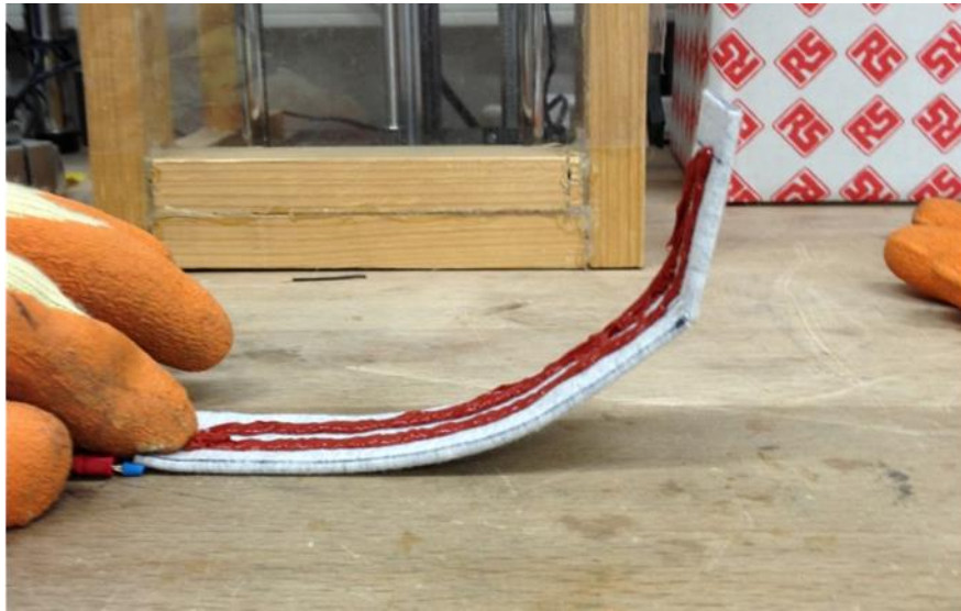
Fig. 5.3 L'aumento della lunghezza del filo a 14 cm determina un incremento notevole della curvatura.
