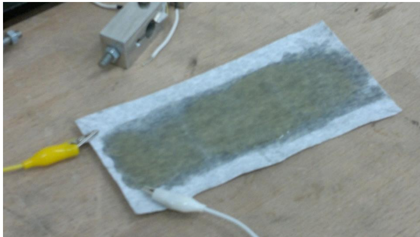
Fig. 3.5 Tessuto composito in resina epossidica con filo SMA
