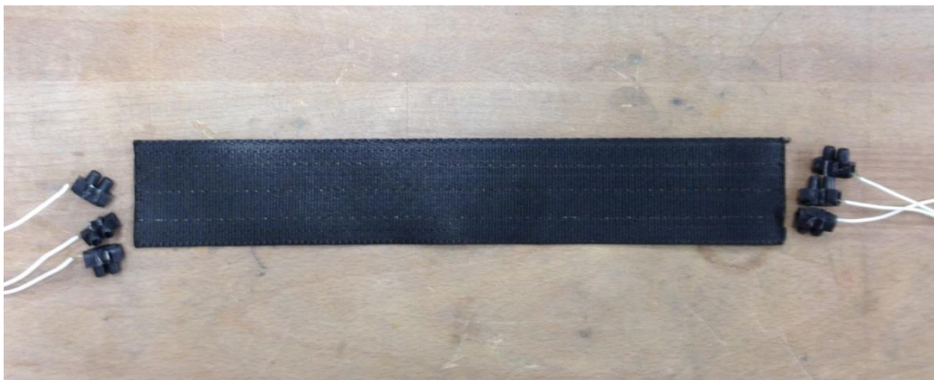
Fig. 3.2 Cintura di sicurezza con filo SMA cucito a macchina
