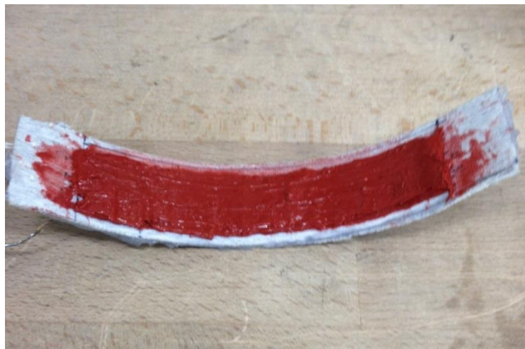
Fig. 5.11 Provino SWeAT attuato con 6 fili da 150 \mu\text{m}
