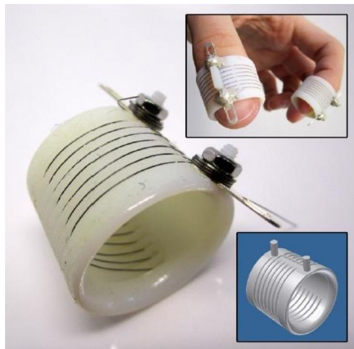
Fig 2.20 Attuatore indossabile a base SMA per la riproduzione di impulsi tattili [23]
