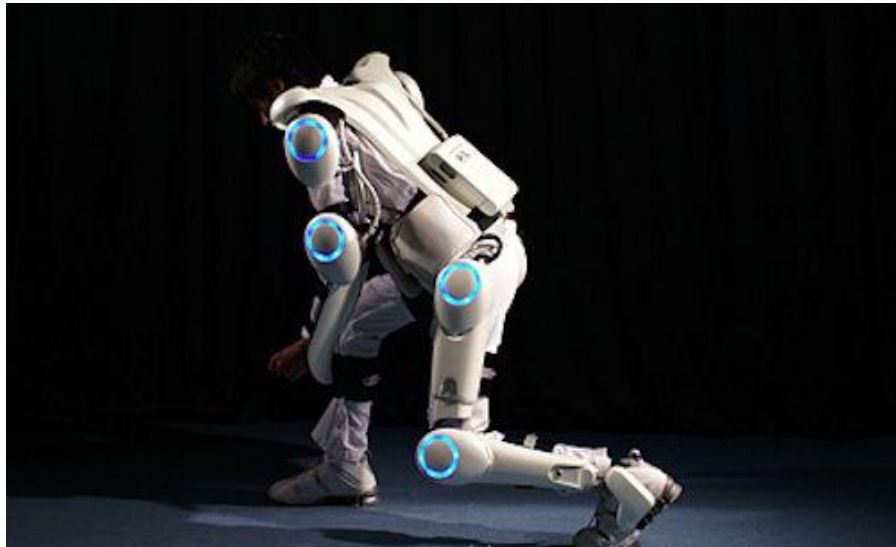
Fig 2.6: Il sistema HAL, progettato per l'assistenza delle attività locomotorie [10],[11]
