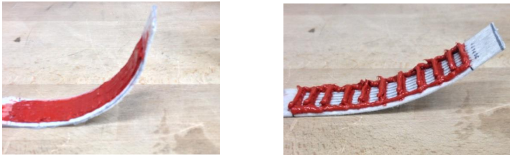
Fig. 5.14 : Confronto tra le diverse performance dei due provini. Nella foto di destra la corsa massima in altezza è di 8 cm, a sinistra di soli 4.8 cm
