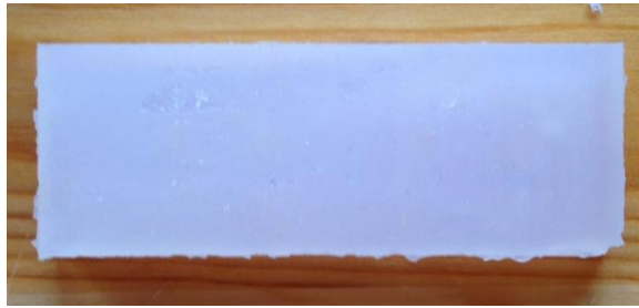
Fig. 5.16 Campione di silicone (spessore 4 mm) usato per il calcolo della k a trazione
