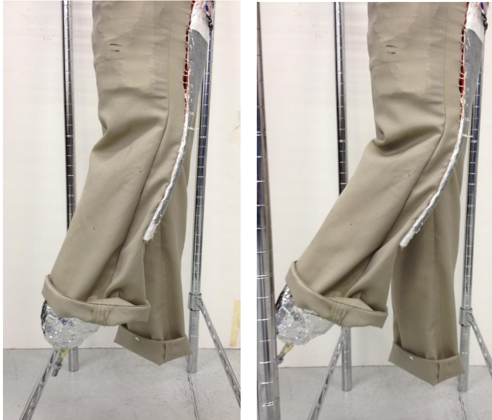
Fig. 5.27 L'attuatore SWeAT montato sulla gamba realizzata in laboratorio in posizione intermedia (sinistra) e di massima escursione (destra)
