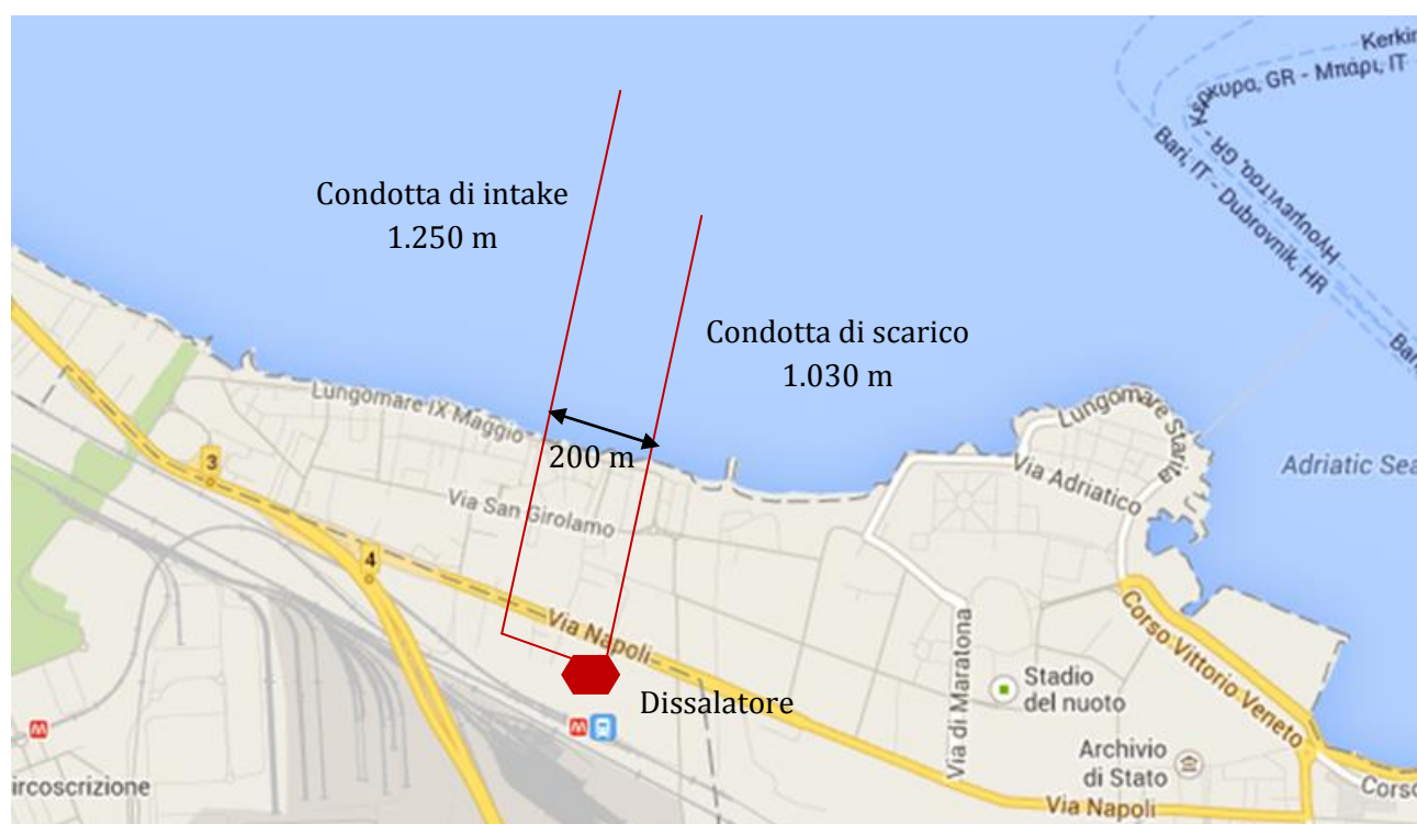
Figura 5.3.7 – Rappresentazione della collocazione reciproca delle condotte di intake e di scarico per l'impianto simulato di Bari.
