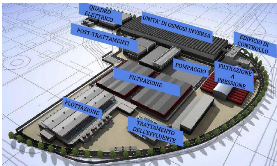
Figura 5.1 – Rendering dell'impianto di dissalazione ad osmosi inversa realizzato nella città di Barcellona: nell'immagine sono evidenziate i principali componenti del processo (Pere Verger Cortès, 2012).
