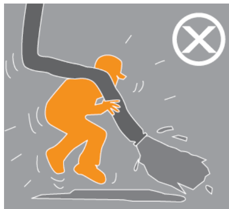
Fig. 176 Errato utilizzo pompa
