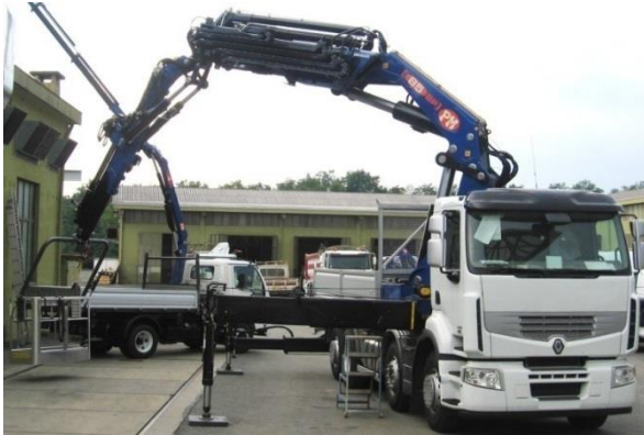
Fig. 157 Autocarro dotato di gru, posizionato correttamente con gli stabilizzatori poggiati sul terreno
