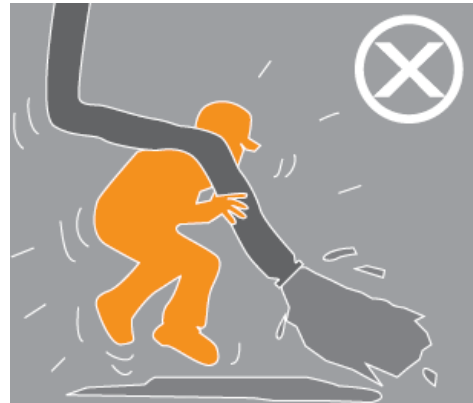
Fig. 204 Errato utilizzo pompa
