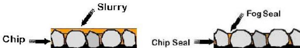
Figura B.7: confronto tra il trattamento di Slurry Seal e di Fog Seal
