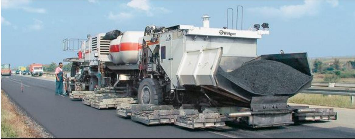
**Figura B.10: macchinario per il riciclaggio a caldo**
