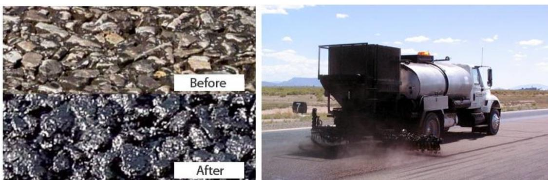
**Figura B.4: (a) Fog Seal: prima e dopo l'applicazione del trattamento; (b): macchina per il Fog Seal**
