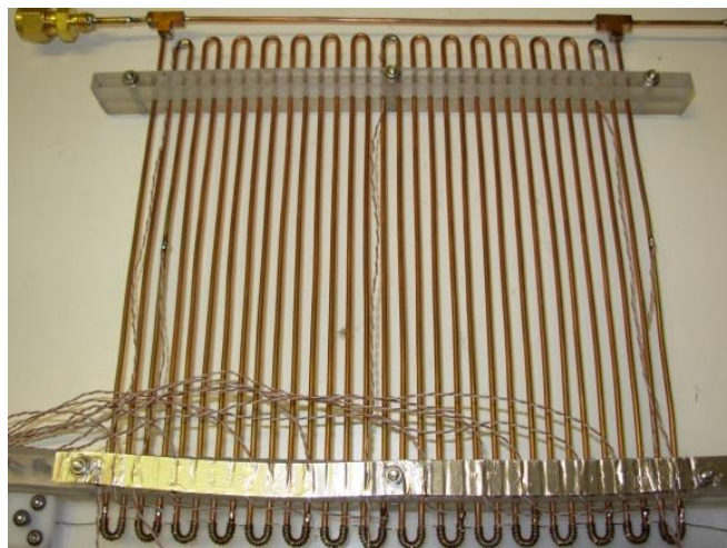
Figura 1-3 Pulsating heat pipe formata da serpentina in rame
