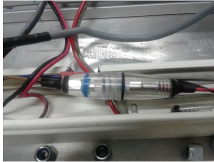
Figura 2-29 Particolare fusibile all'interno dell'apposito contenitore
