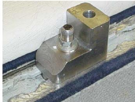
Figura 1-14 Particolare degli attacchi per i rack ai binari, possono essere inseriti con un passo pari a 1''
