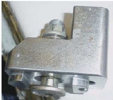
Figura 1-14 Particolare degli attacchi per i rack ai binari, possono essere inseriti con un passo pari a 1''
