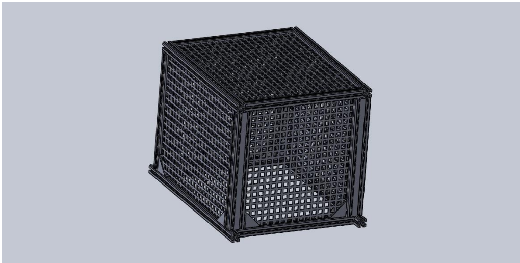
Figura 2-11 Gabbia di protezione per la PHP e tutto il suo involucro compreso di ventilatori, la lamiera forata protegge da intrusioni accidentali permettendo la circolazione dell'aria
