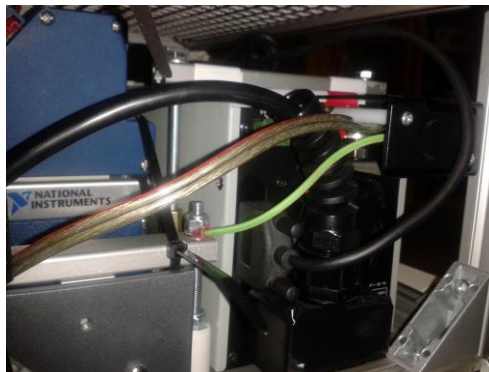
Figura 2-26 Particolare modifica nel retro dell'alimentatore delle resistenze
