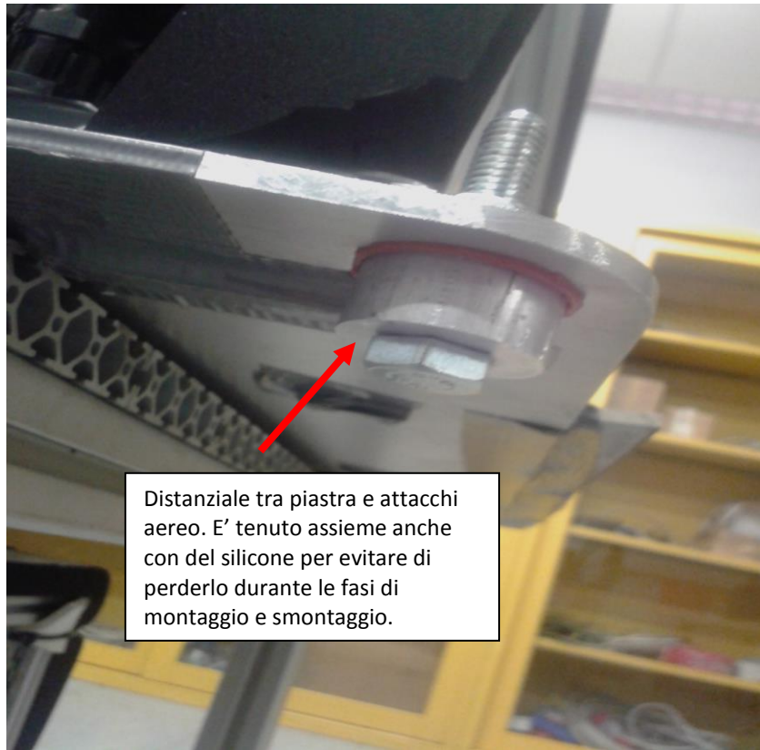
Figura 2-22 Particolare distanziale per passaggio vite che blocca la piastra ai binari dell'aereo. In questa foto è tenuto bloccato da un bullone con vite montata nel verso contrario a quello che avrebbe sull'aereo.
