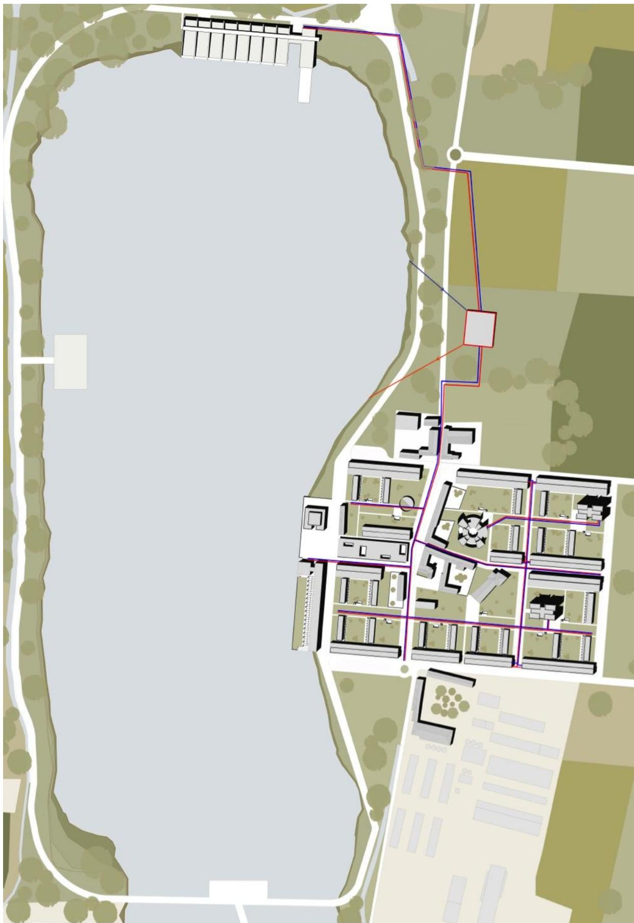
*Planivolumetrico: schema rete distribuzione impianto geotermico*
