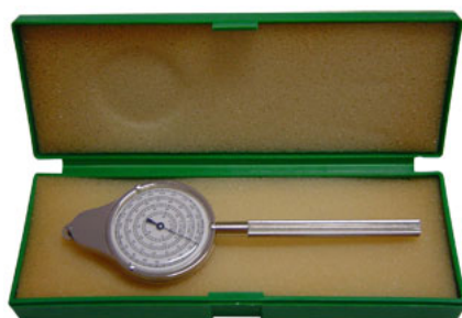
Figura 2.15: Curvimetro analogico, particolare strumento usato per calcolare la lunghezza di una curva.
