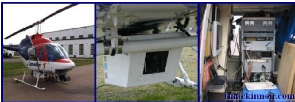
Figura 2.11: Dettaglio di un sistema LiDAR fissato ad un elicottero.
