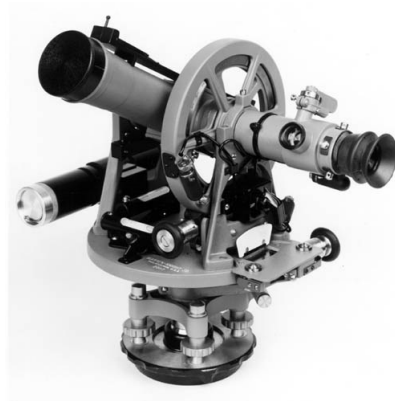
Figura 2.16: 400-8403 Pilot Balloon Theodolite, usato in applicazioni militari.
