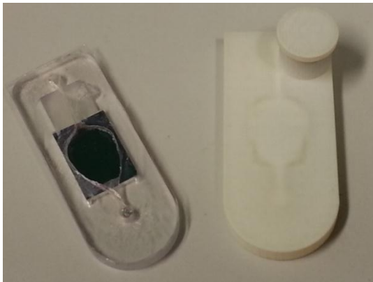
Figura 21 Cartucce per estrazione di materiale genomico con il sistema automatico in via di sviluppo; sono state realizzate con la fresa (sinistra) e con la stampante 3D (destra)
