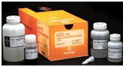
Figura 50: Kit Promega MagneSil ONE, Fixed Yield Blood Genomic System per estrazione di DNA da sangue. Da sinistra ci sono il flacone di Alcol, quello di Magnesis PMPs, il buffer di lisi e il buffer di eluizione. In basso, la provetta di anticoagulante
