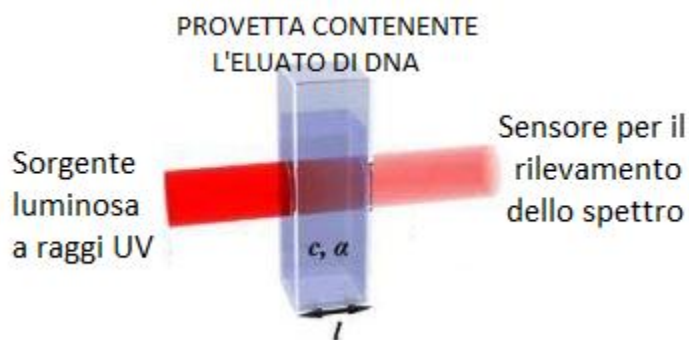
Figura 7 Schema di funzionamento dello spettrofotometro
