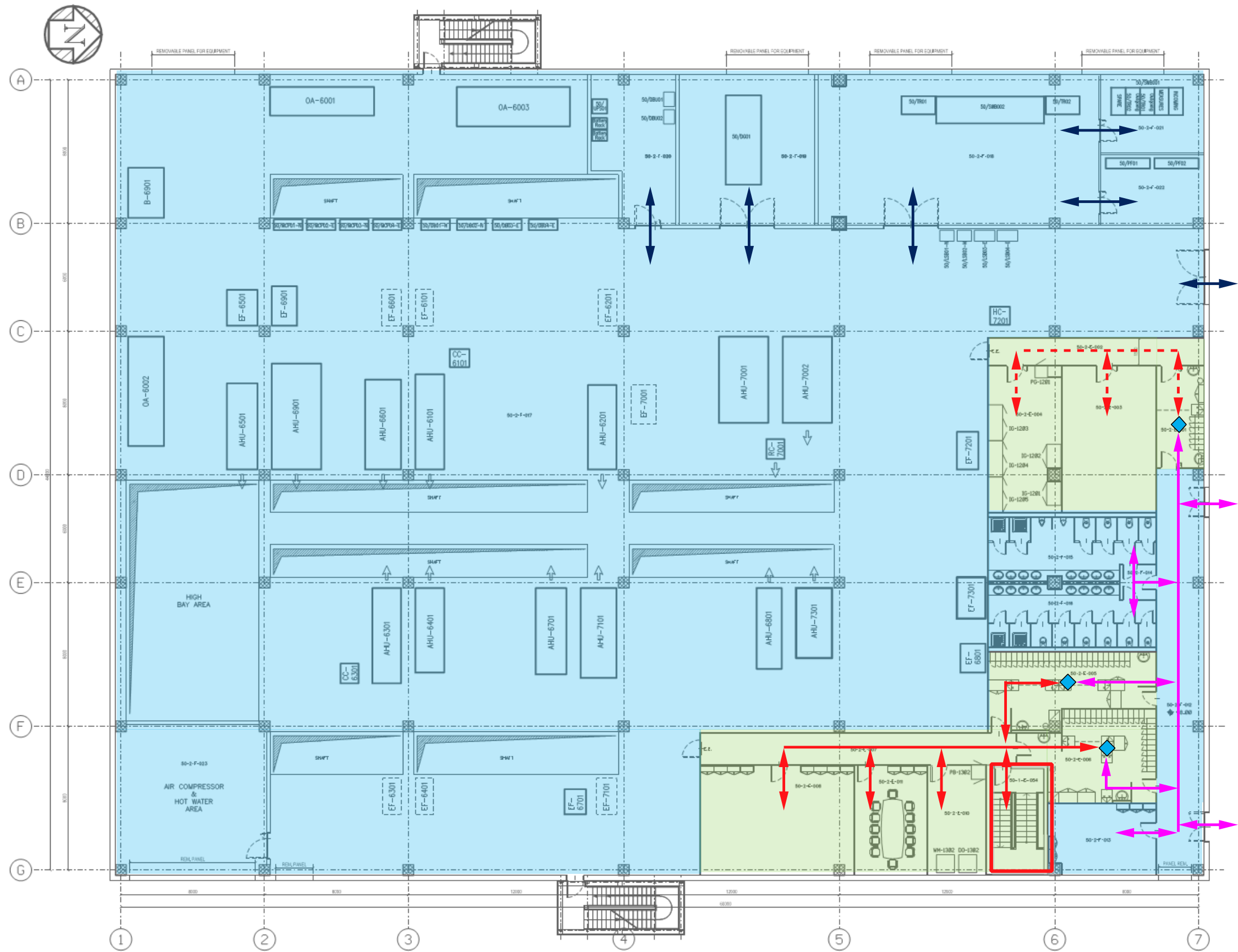
Figura 3. 4 – Layout dei Flussi del Personale e Classificazione dei locali dell’impianto produttivo in funzione del grado di pulizia voluto. Primo piano dell’edificio di produzione. In rosso è evidenziata la scala interna classificata che collega piano terra e primo piano
