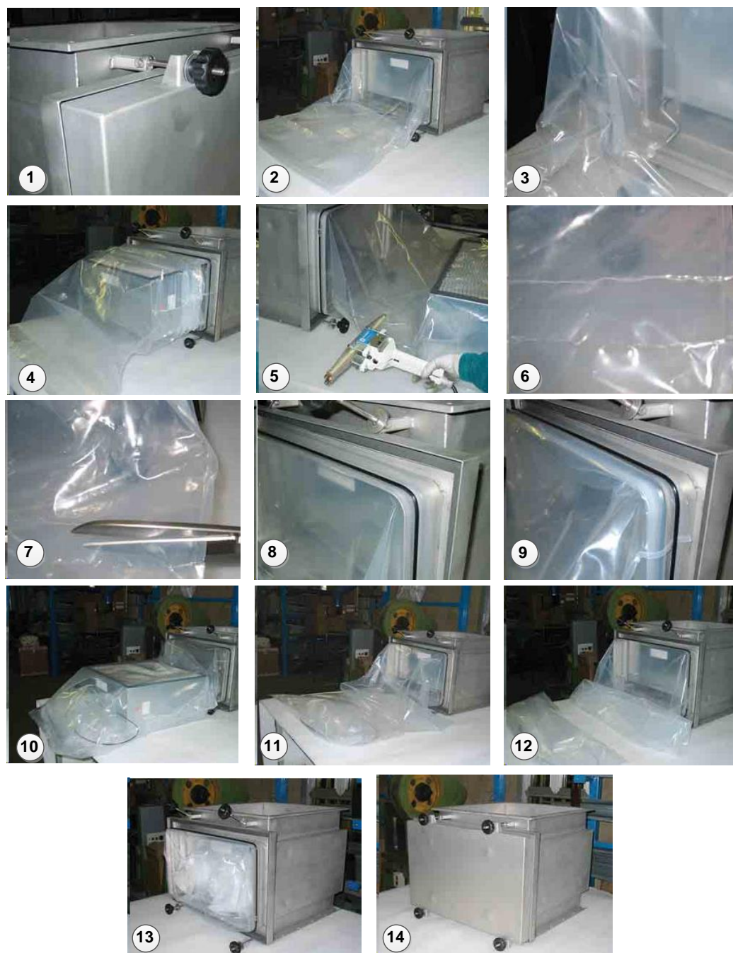
Figura 5. 10 – Sequenza illustrata del procedimento di sostituzione di un filtro in un sistema CANISTER.
